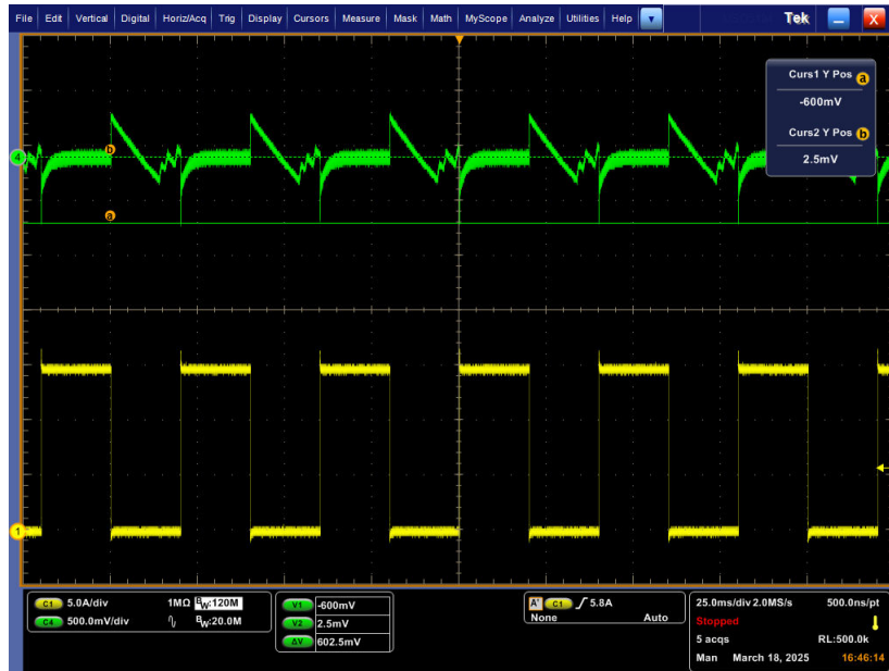
图 3-8. 10mA 至 15A 瞬态，压摆率为 1A/us ( Ch4 = V_{OUT} 交流耦合；通道 1 = I_{OUT} )
