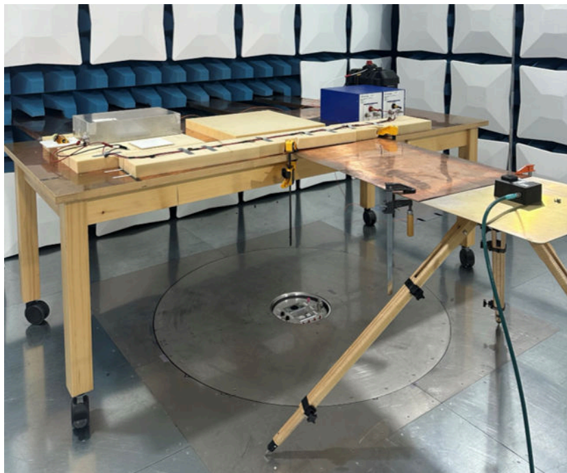
图 3-7. TIDA-060048 的 CISPR 25 5 类测试设置
