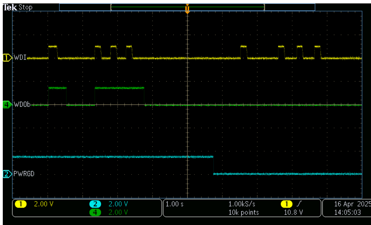
图 3-10. 当 PWRGD 指示通道 1/2 不再处于调节状态时，WD_TMR = 56.2kOhms
