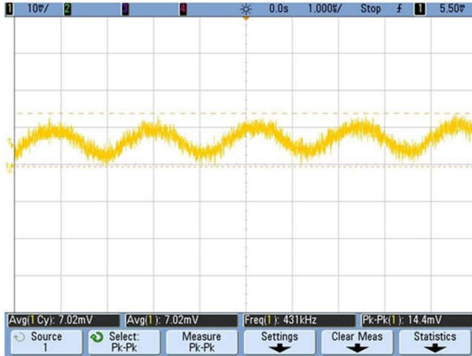
图 3-15. TPS54218 2V 电源输出电压纹波
