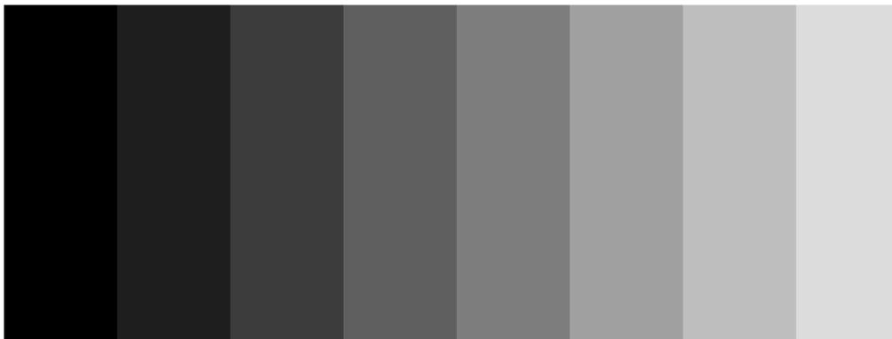
图 3-2. 固定步长水平斜坡测试图形示例
