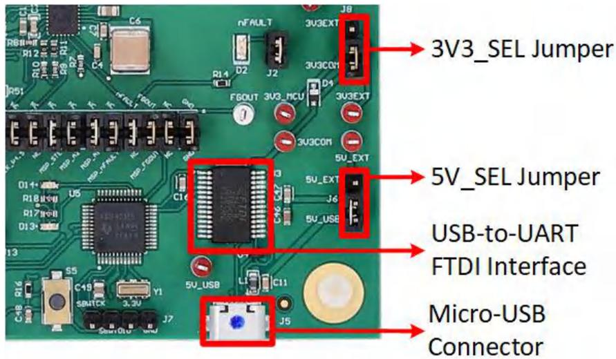
图 2-4. Micro-USB 连接器和 USB 转 UART 接口
