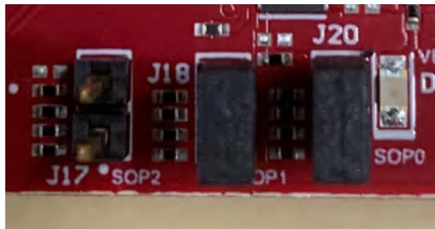
图 2-28. SOP 跳线
