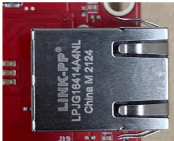
图 2-12. RJ45 连接器
