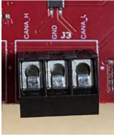
图 2-10. CAN\_A 连接器
