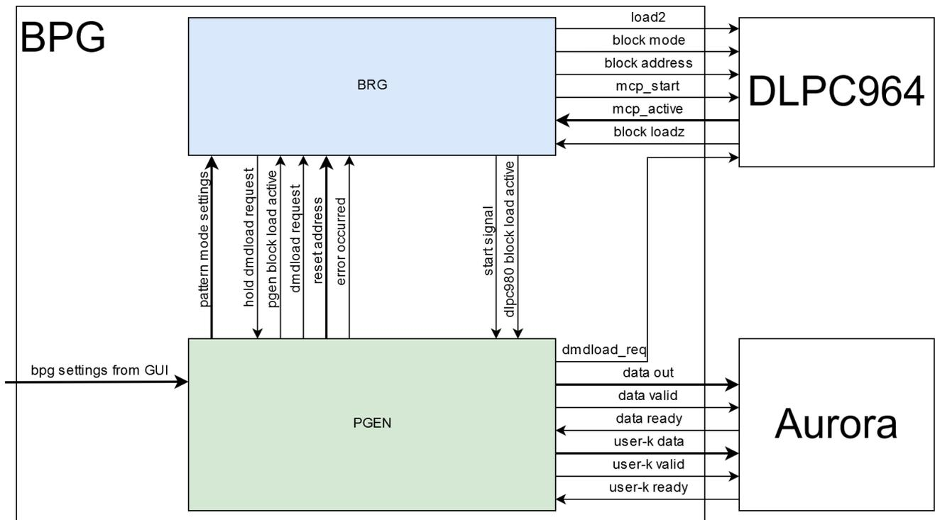
图 2-2. BPG 模块硬件方框图
