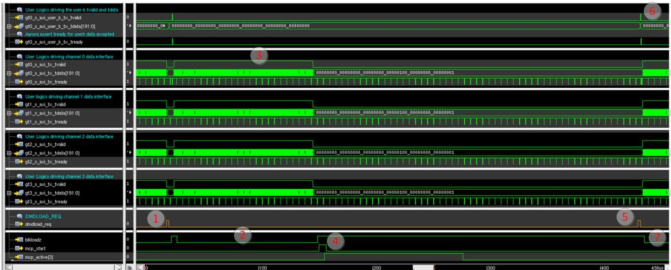
图 4-20. DMDLOAD\_REQ 延迟置为有效波形
