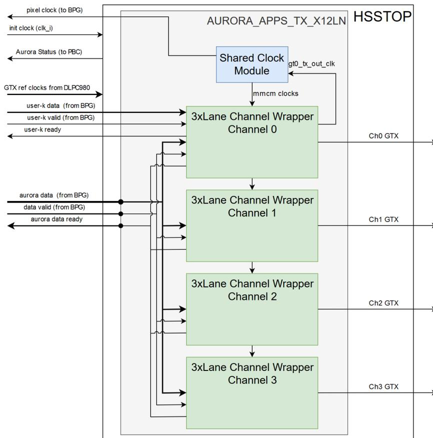
图 2-8. HSSTOP 模块硬件方框图
