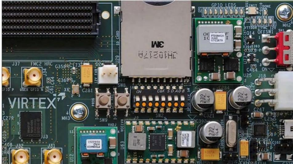
图 4-10. GPIO DIP 开关 (VC707)
