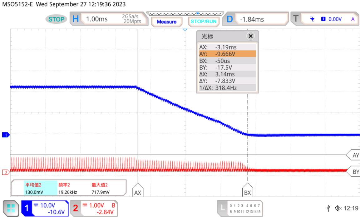
图 3-11. 电流快速衰减阶段
