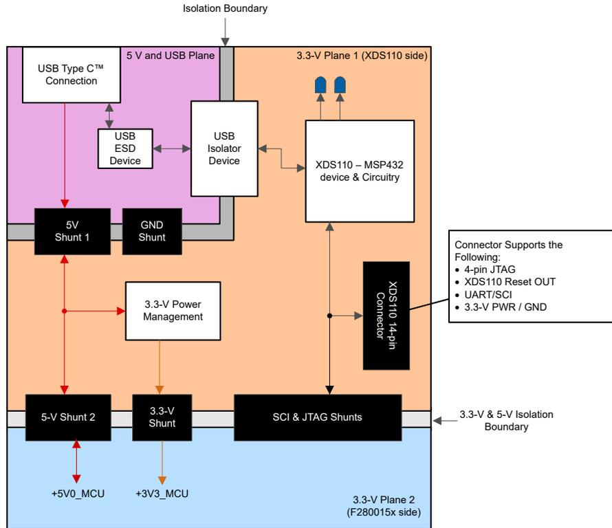
图 3-3. LaunchPad 电源平面图
