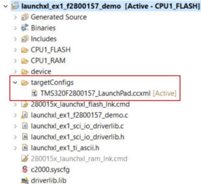
图 5-2. 演示工程中包含的目标配置
