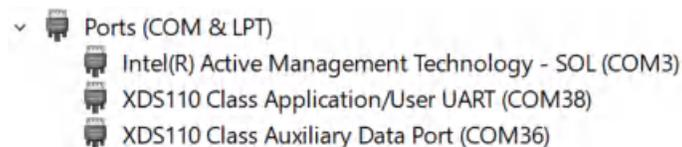
图 2-1. LaunchPad XDS110 COM 端口
