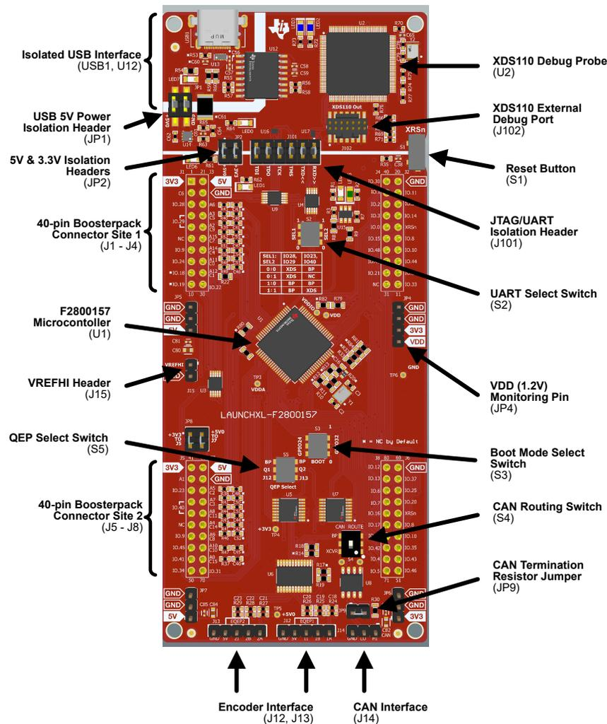
图 1-1. LAUNCHXL-F2800157 LaunchPad™ 电路板概述
