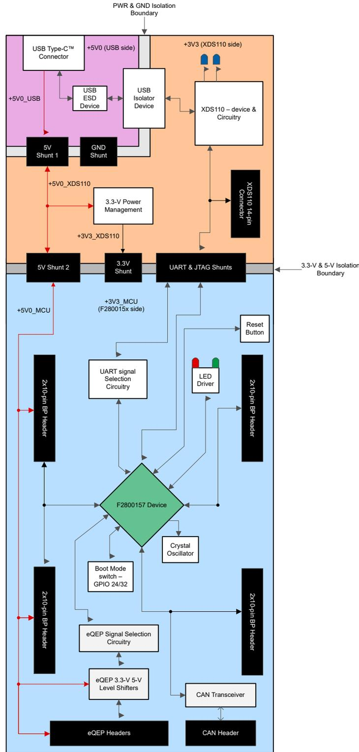
图 3-1. F280015x LaunchPad™ 开发套件方框图
