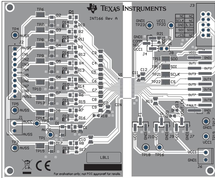
图 3-2. ISO1228DFBEVM PCB 布局 - 复合顶视图
