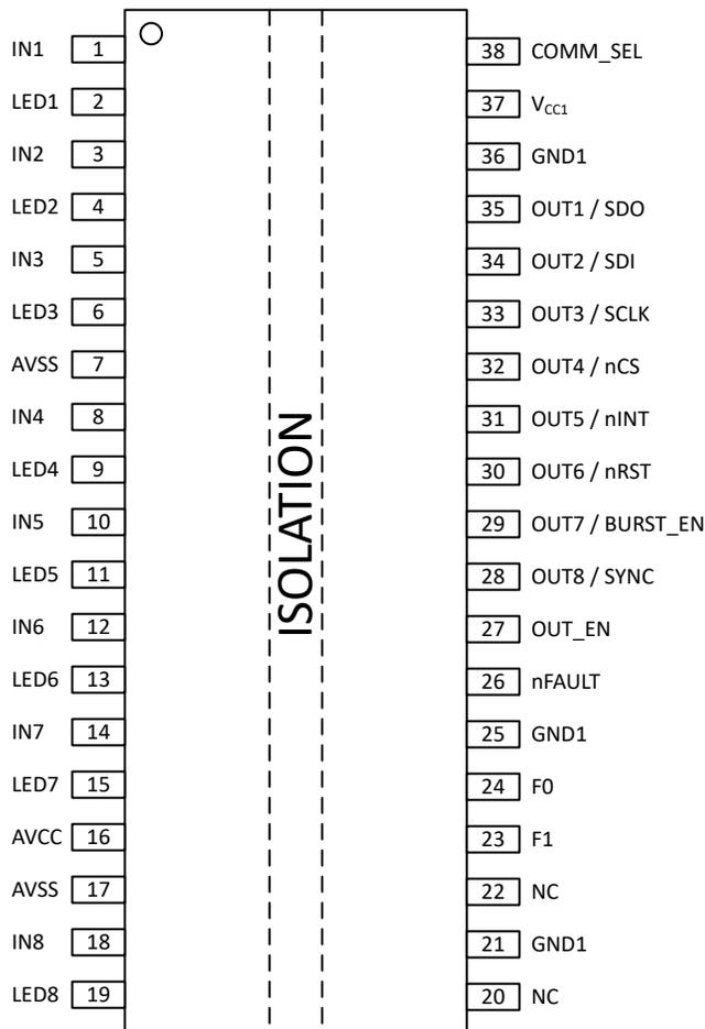
图 2-1. ISO1228 隔离式数字输入接收器引脚配置
