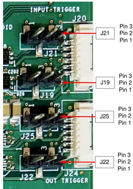
图 4-6. DLP LightCrafter 单 DLPC900 EVM 触发电压电平选择器
