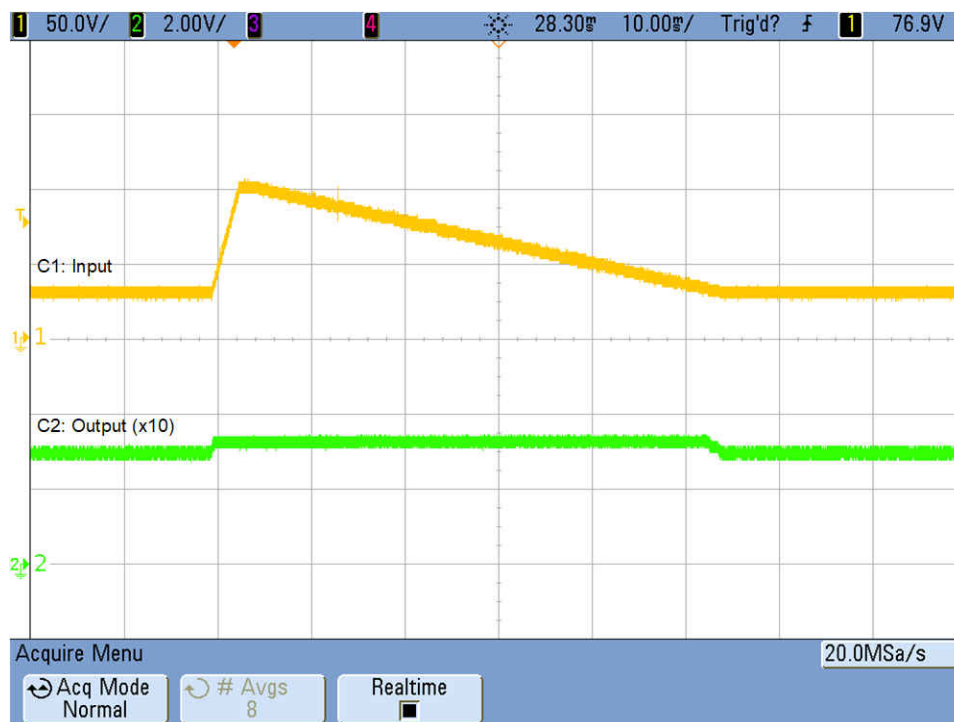
图 3-9. 100V 浪涌事件：低电流
