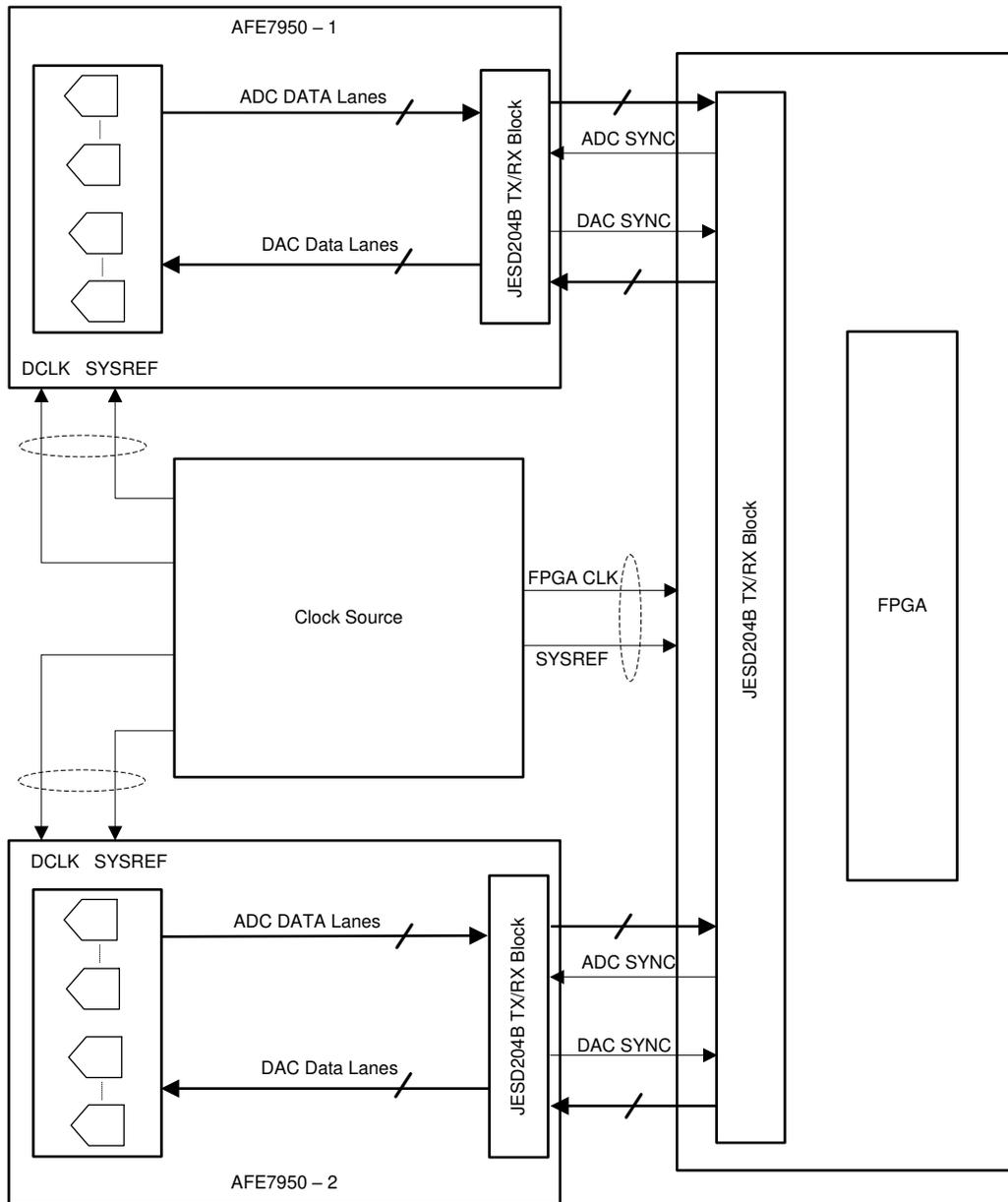
图 1-2. Synchronization Block Diagram
