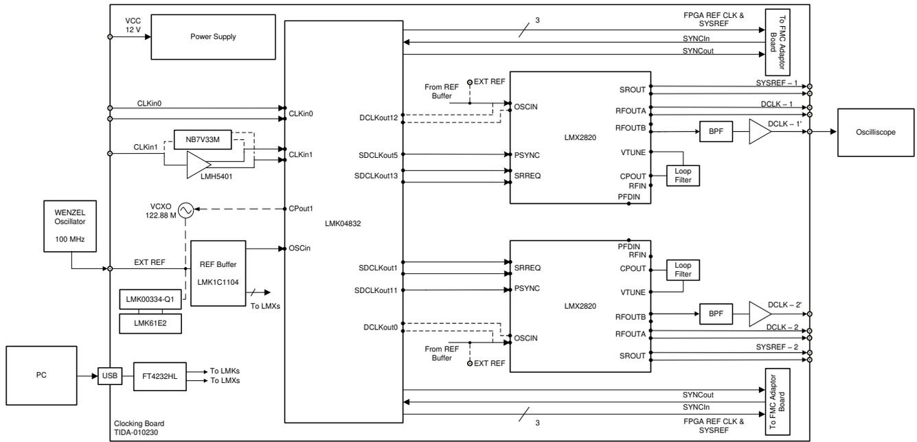
**图 2-7. Test Setup for LMX2820 Phase-Noise Measurement**
