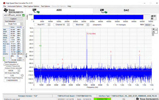
图 4-10. 载波频率为 718MHz 时的本底噪声
