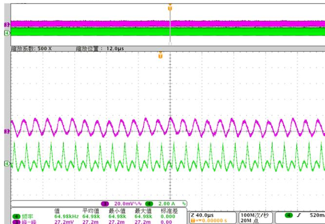
图 17. 115-V AC 60-HZ Input, 9-V, 2.5-A Output
