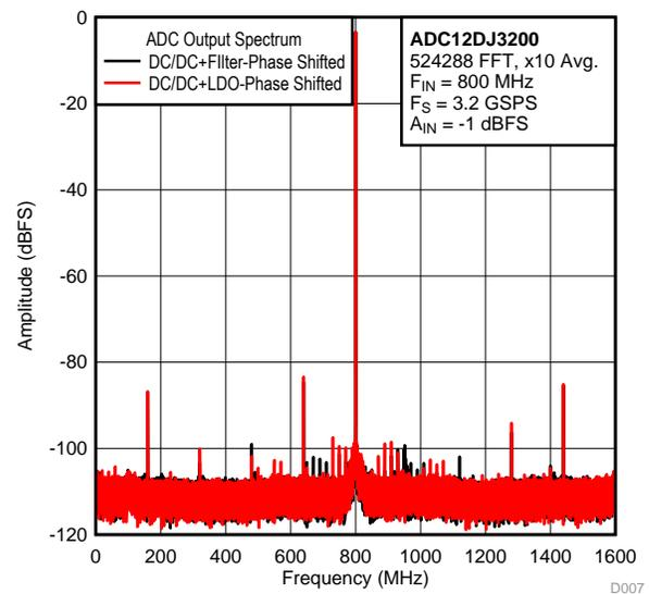
图 24. ADC Output, Filter vs LDO ( $F_{IN} \pm 3$  MHz)
