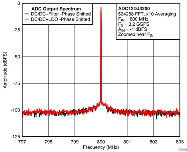
图 25. ADC Output, Filter vs LDO (Near DC)
