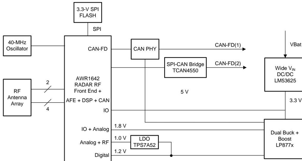
图 1. Radar Module Block Diagram
