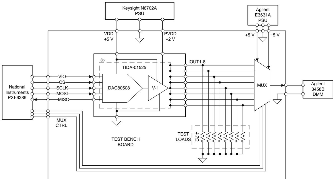
图 8. Test Setup Block Diagram
