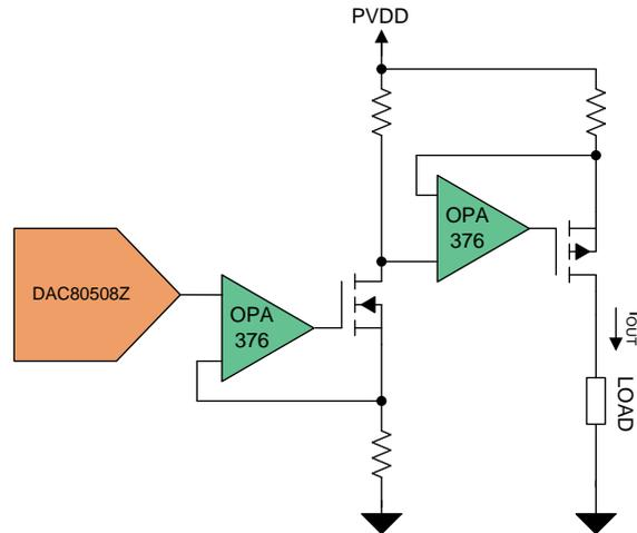
图 1. TIDA-01525 Block Diagram
