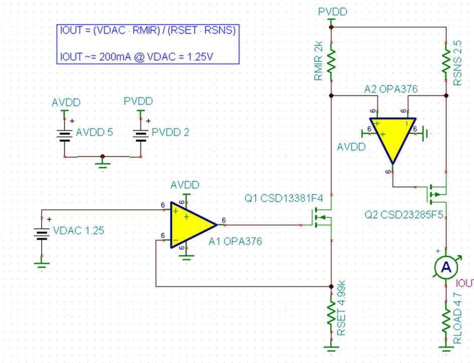
图 4. Simulation Using TINA-TI™ Software
