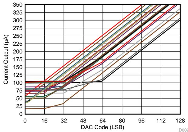
图 11.  $I_{\text{OUT}}$  Near Zero-Scale
