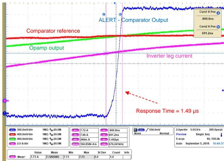
图 45 显示了负逆变器腿电流的过电流检测（正逆变器腿电流指的是负绕组电流）。图 46 显示了过电流检测的响应时间，响应时间约为 1.4  $\mu\text{s}$ 。
