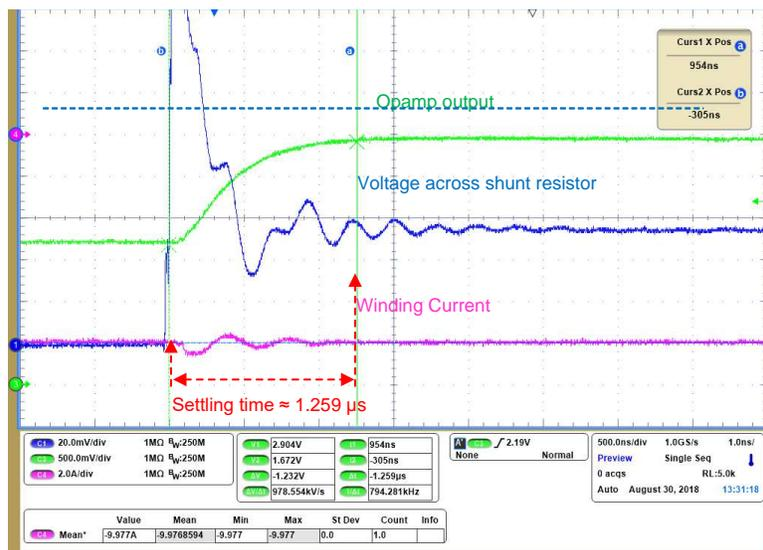
图 30 和 图 31 显示在 12 A 绕组电流下的阶跃响应。电流检测放大器输出的 settling time 为 1.34  $\mu\text{s}$ 。更快的 settling time 和轨到轨输出能力有助于最大限度地减少电流检测失真，尤其是在较低占空比下。
