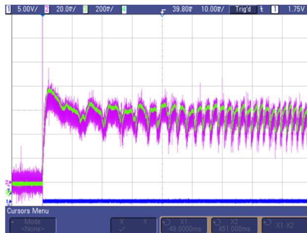
将电流检测信号直接在检测电阻上，与经过 DRV8703-Q1 电流检测放大器后的信号进行比较，显示放大后的 I\_SENSE 信号（通道 3）与电机检测电阻上的电压（通道 2）相比，没有表现出任何显著的时间延迟。检测电阻上的信号表现出高度的噪声，因为示波器设置处于最低可用范围，为 20 mV 每格。
