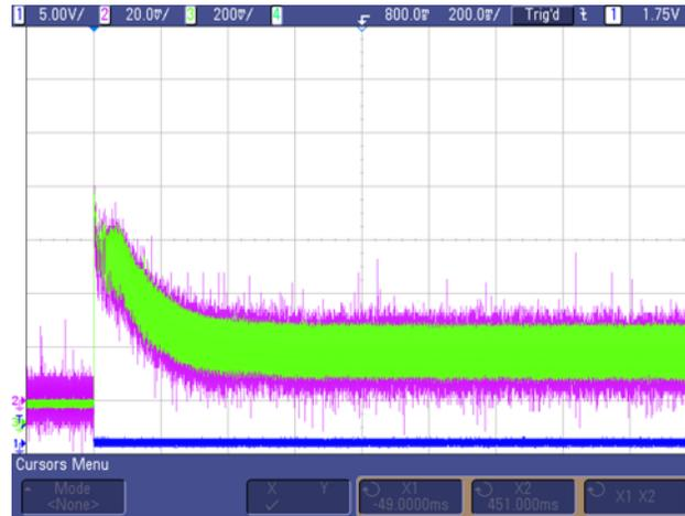
图 20 显示的是电机启动期间的电流信号放大视图。电流纹波在通道 3 的 I\_Sense 信号上更容易看到，它是通道 2 的信号（跨电流检测电阻的电压）的放大版本。
