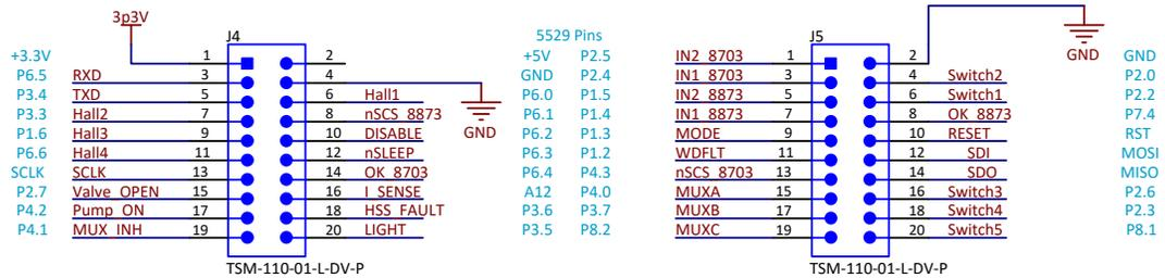
如果设计者想要用不同的微控制器来评估此设计，相同的输入、输出和电源连接可以使用，请记住 TIDA-020008 板是为 3.3-V 微控制器设计的。模拟到数字的缩放和通用 I/O (GPIO) 信号可以修改以适应 5-V 微控制器，如果这是所需的。
