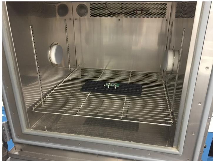
图 19. Temperature Test Setup
