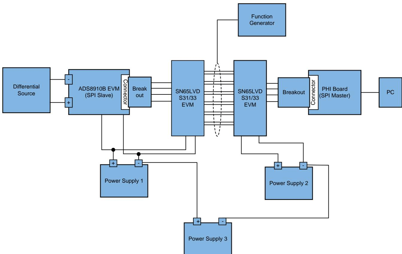
图 11. SPI Over LVDS Test Setup
