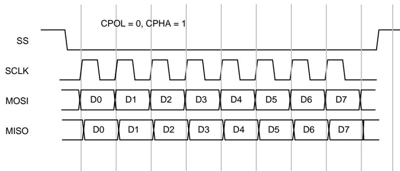
图 4. SPI Timing Diagram
