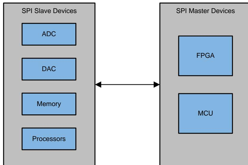
图 1. System Diagram
