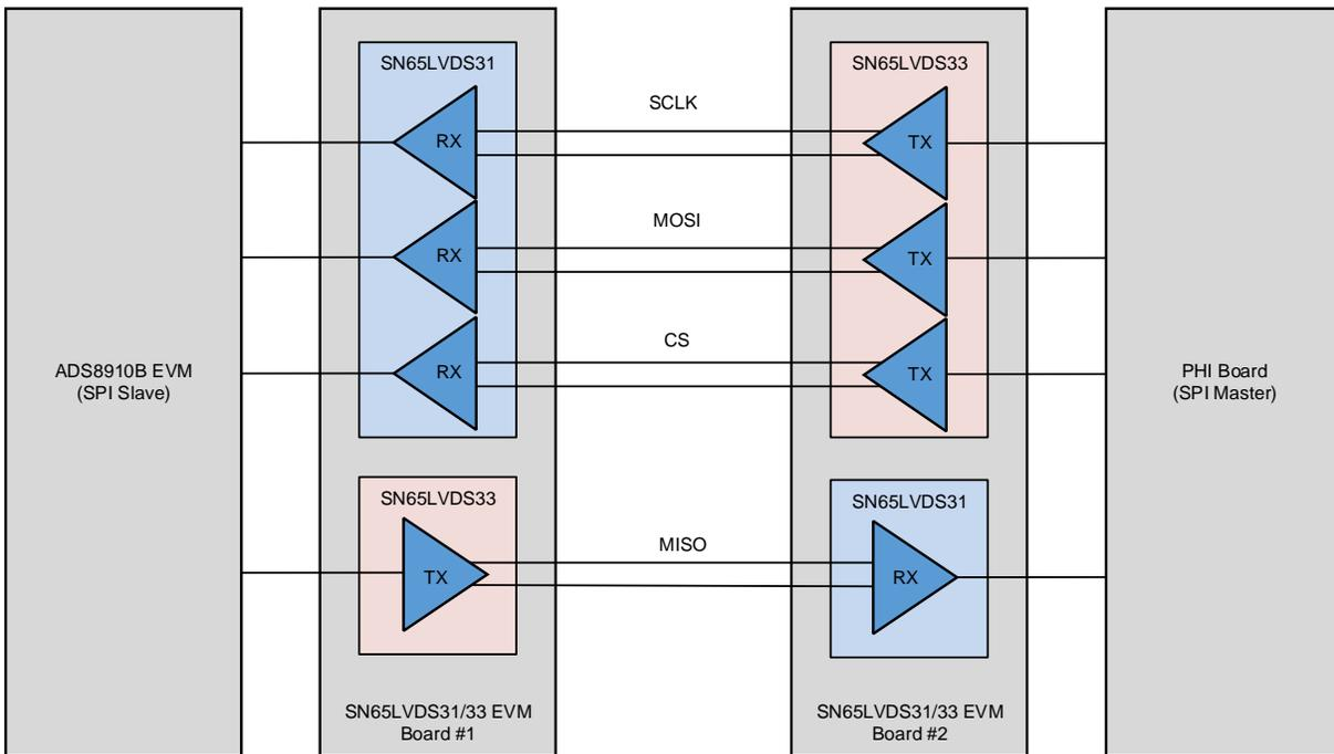
图 2. TIDA-060017 Block Diagram
