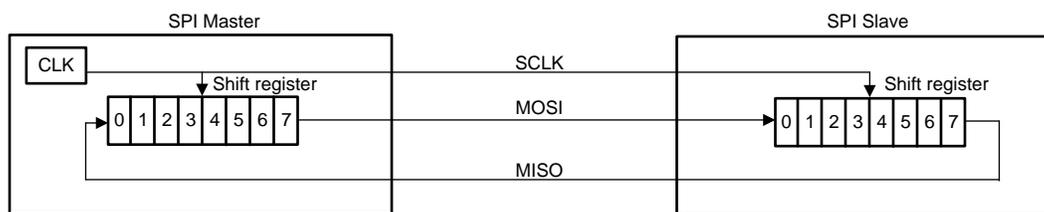
图 3. SPI Block Diagram
