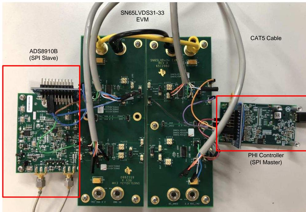
图 9. Hardware Setup
