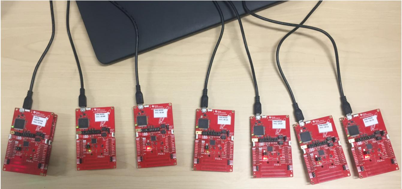
图 16. 6-Hop Linear Topology Setup
