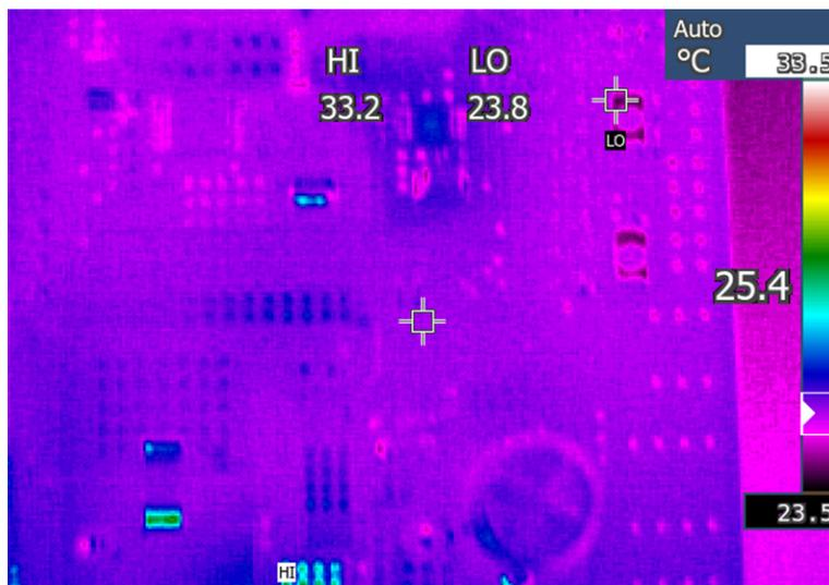
图 31. Standby Thermal Test
