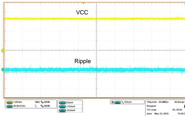
图 15. 3.3-V Voltage and Ripple
