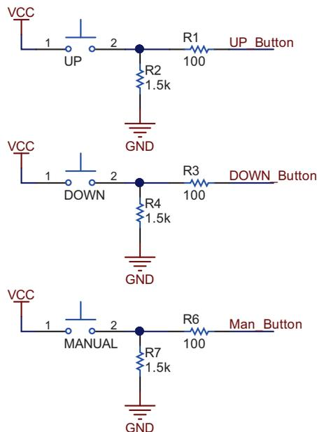
图 9. Push-Button Circuit
