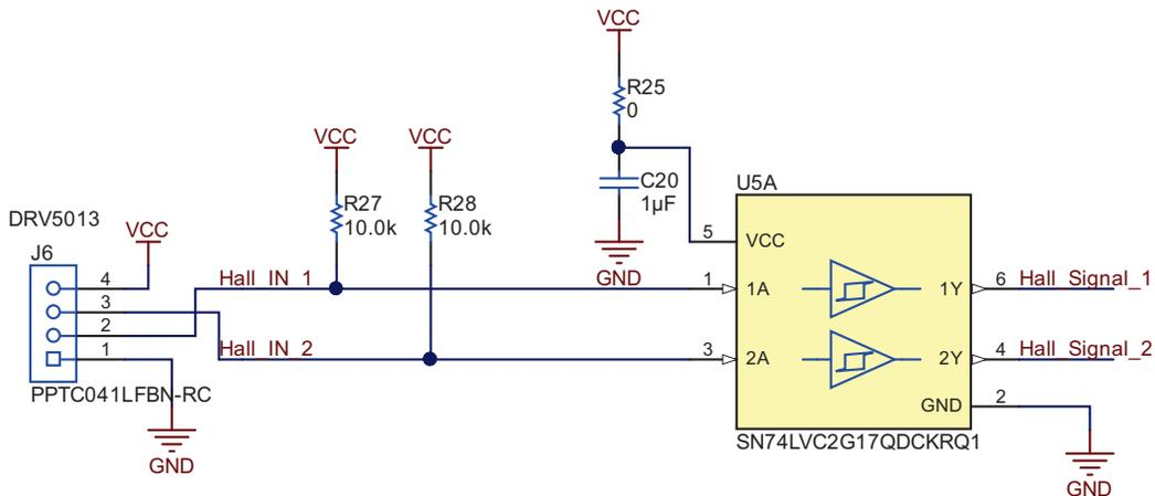
图 7. Hall Effect Sensor Circuit
