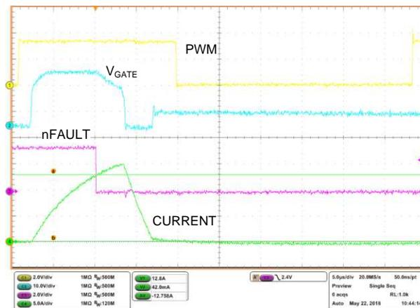
图 27. DRV8703-Q1 Overcurrent Protection
