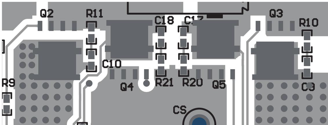
图 38. MOSFET Drain Layout
