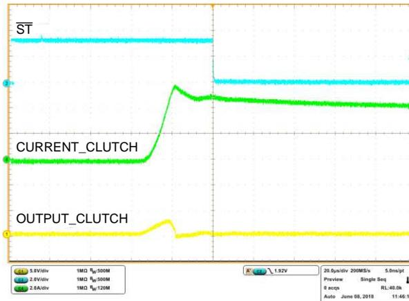
图 28. TPS1H100-Q1 Overcurrent Protection
