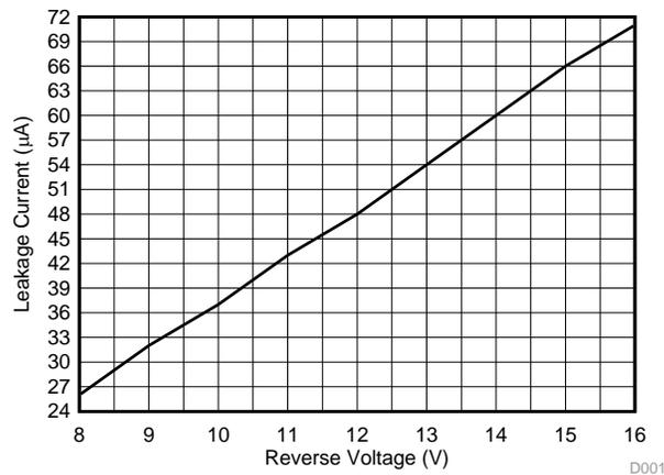
图 17. Leakage Current
