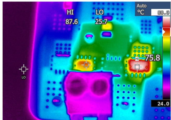
图 34. Reverse Thermal Test
