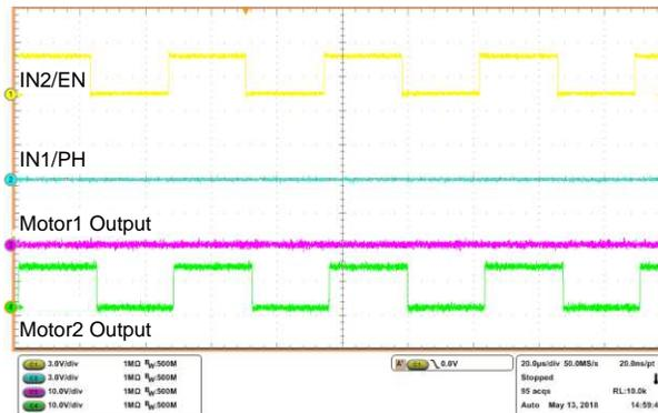
图 19. Reverse Gate drive Signals
