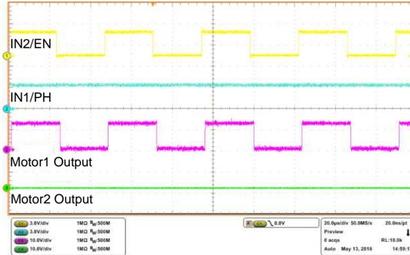
图 18. Forward Gate Drive Signals
