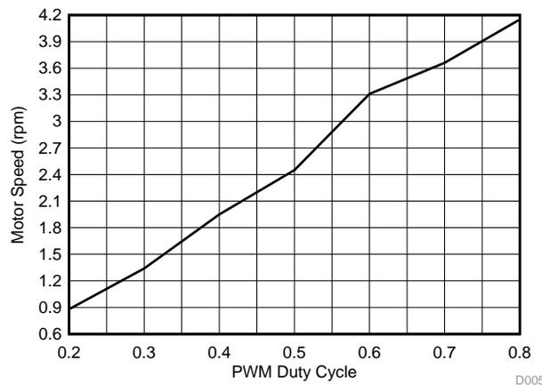
图 29. Motor Speed With PWM Duty Cycle
