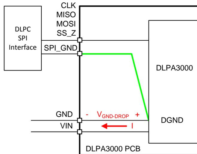
图 6. SPI Connections
