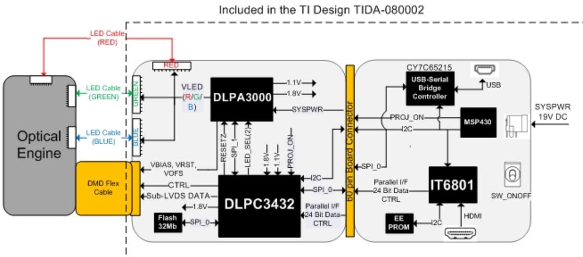
图 1. TIDA-080002 Block Diagram
