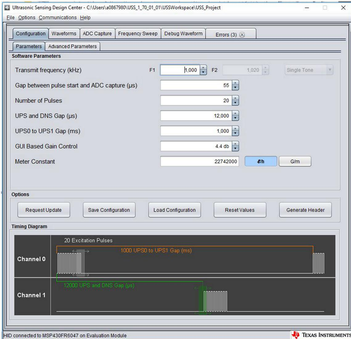
图 10. GUI Configuration Parameters Window
