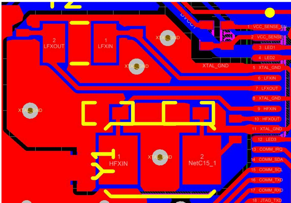
图 27. Layout Guidelines: Oscillator
