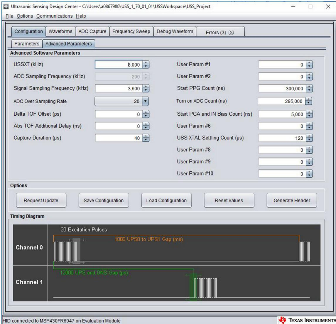
图 11. GUI Advanced Parameters Configuration Window
