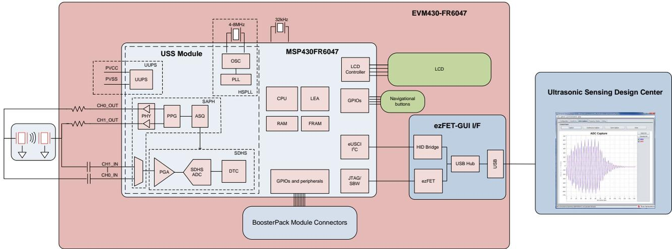
图 1. TIDM-1019 Block Diagram
