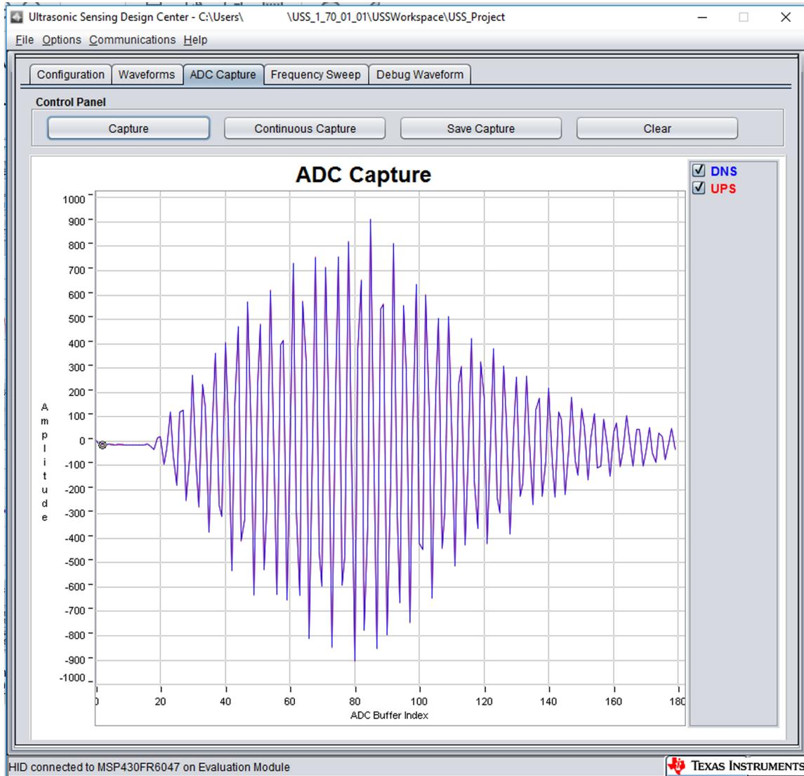
图 13. USS Design Center ADC Waveform Capture Window
