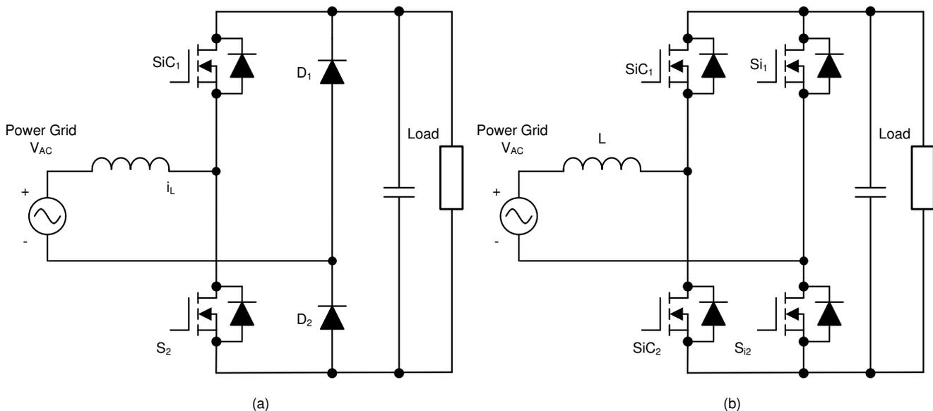
图 1. Totem-Pole Bridgeless PFC Boost Converter Topology:
