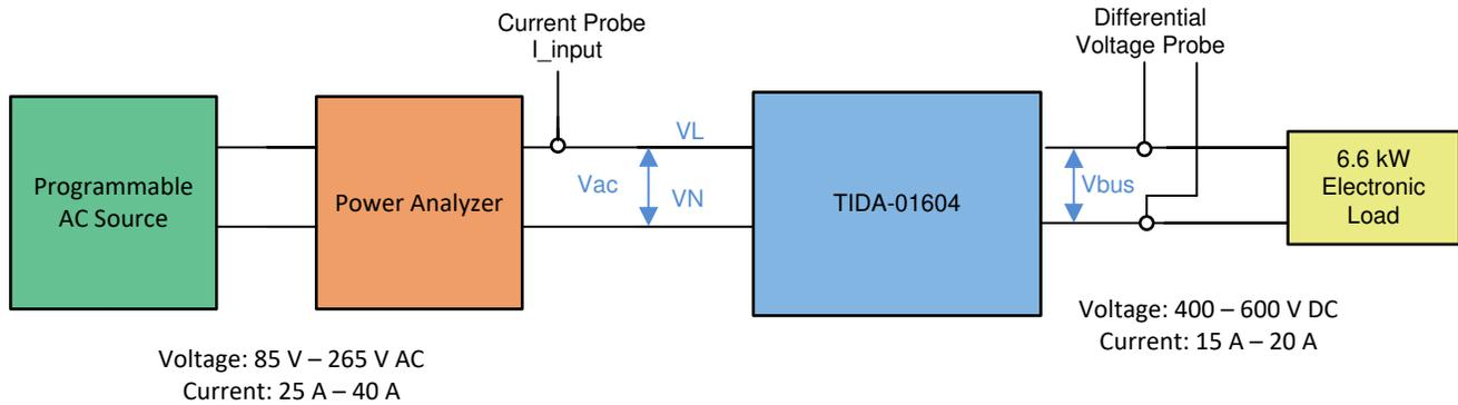
图 18. TIDA-01604 Experiment Setup
