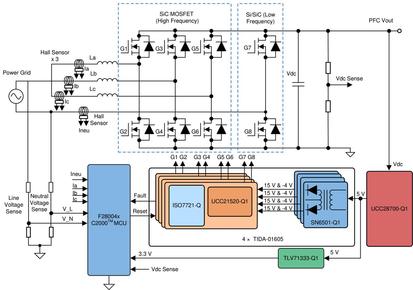
图 4. TIDA-01604 Block Diagram
