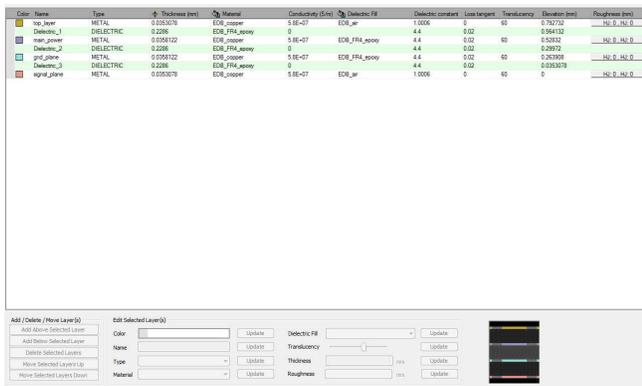
图 8. Slwave Layer Parameter Definition
