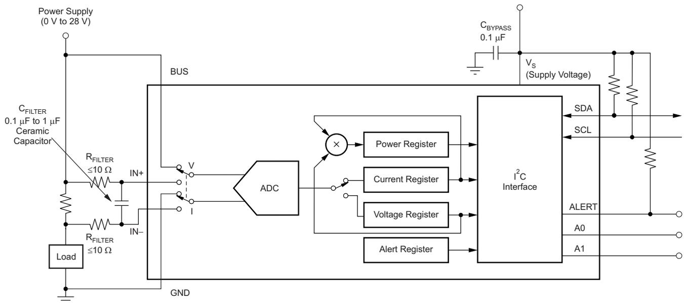
图 3. INA230 With Input Filtering
