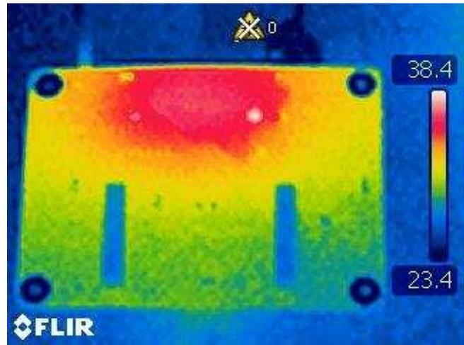
图 13. Bottom PCB Thermal Dissipation Analysis
