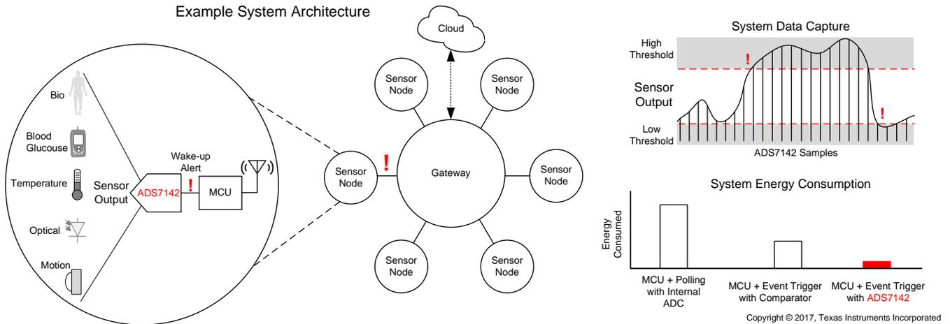
图 4. Example System Architecture
