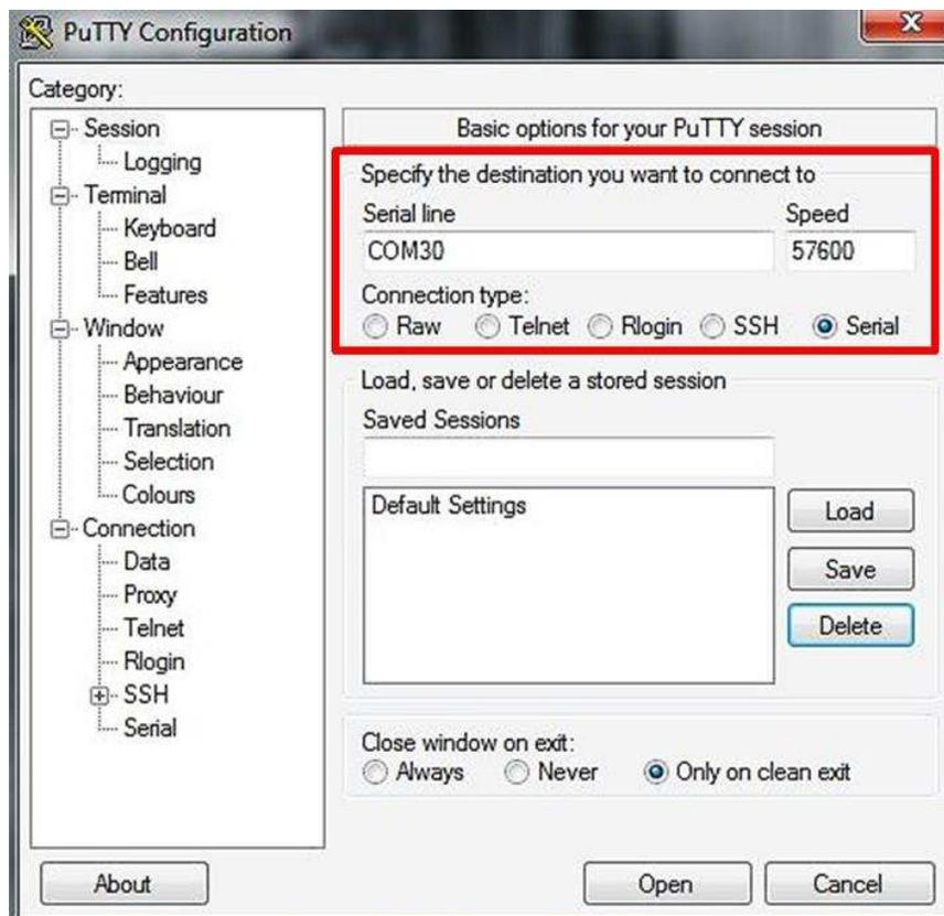
图 38. PuTTY Serial COM Port Settings
