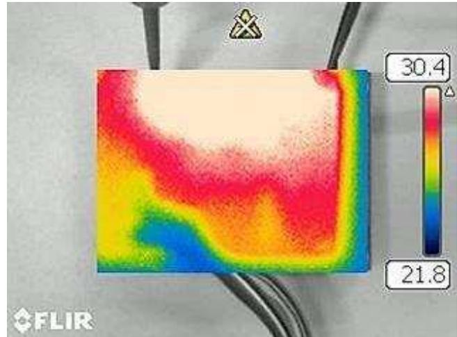
图 15. Top PCB Thermal Dissipation Analysis
