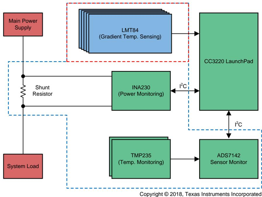
图 1. TIDA-01596 Block Diagram
