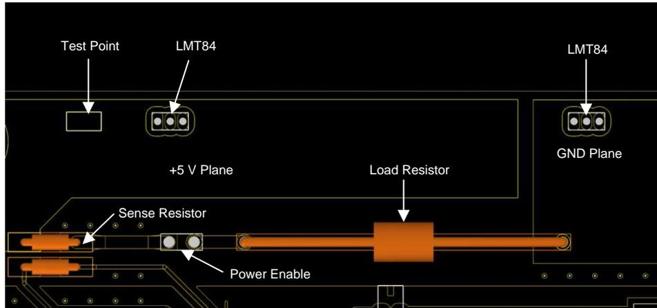
图 7. Slwave Simulation Circuit
