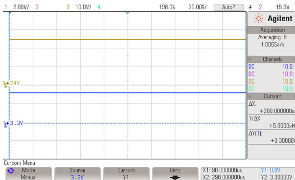
图 3-18. 负载电流为 13 mA 时的纹波电压
