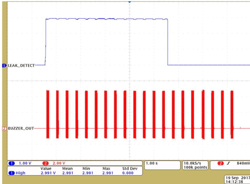
图 26. Leak Detection Response
