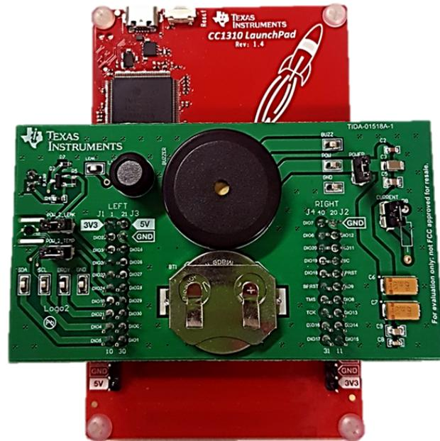
图 16. TIDA-01518 Board Using CC1310 LaunchPad Headers
