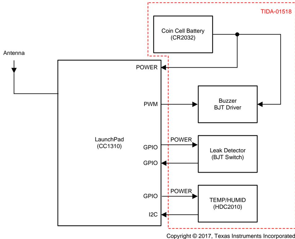
图 1. TIDA-01518 Block Diagram
