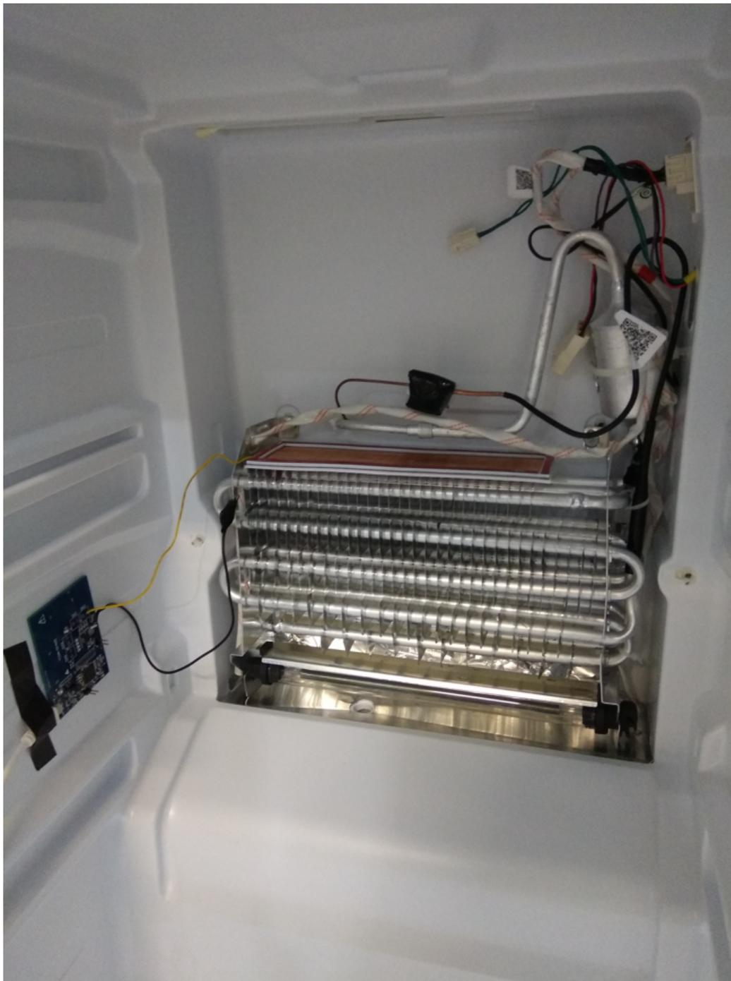
图 23. Evaporator In Refrigerator
