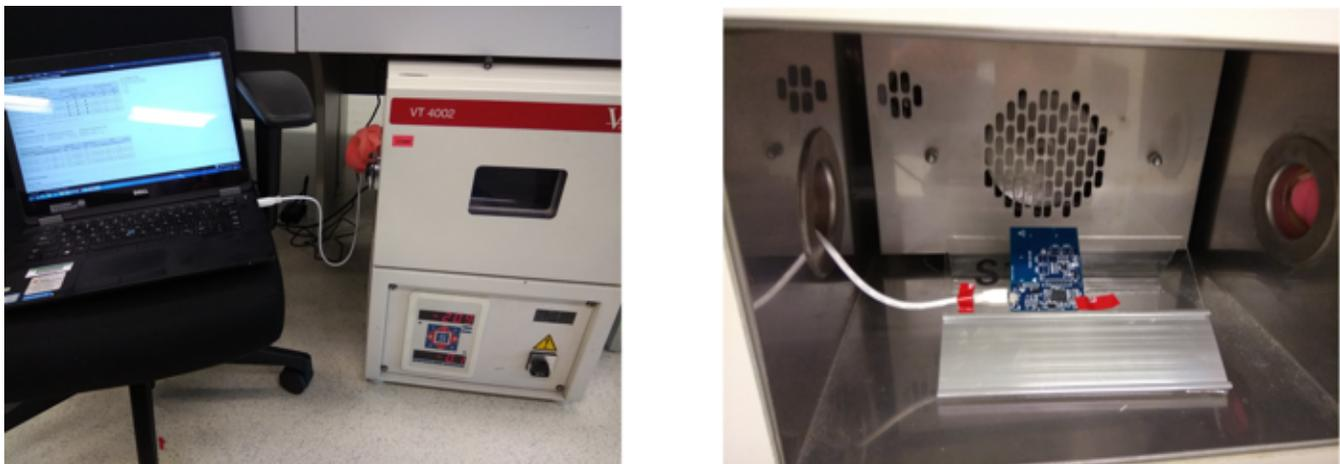
图 31. Temperature Drift Test Setup
