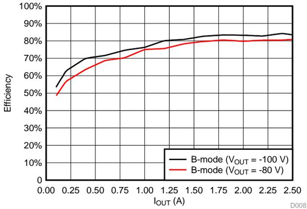
图 53. B-Mode Efficiency (-HV Output)
