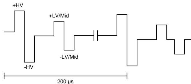
图 7. Five-Level Pulser Output Waveform
