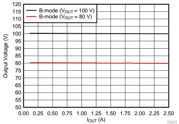
图 45. B-Mode Load Regulation (+HV Output)
