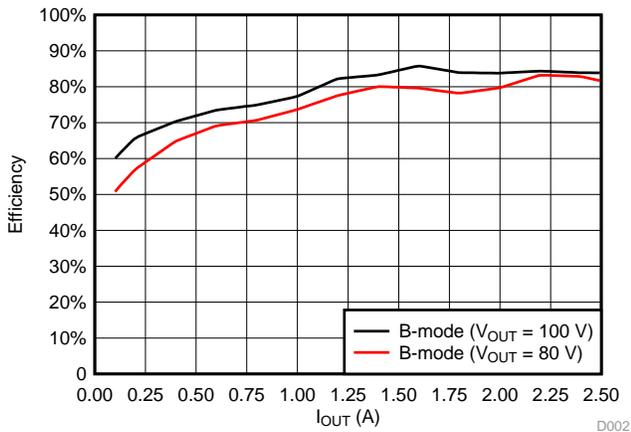
图 44. B-Mode Efficiency (+HV Output)
