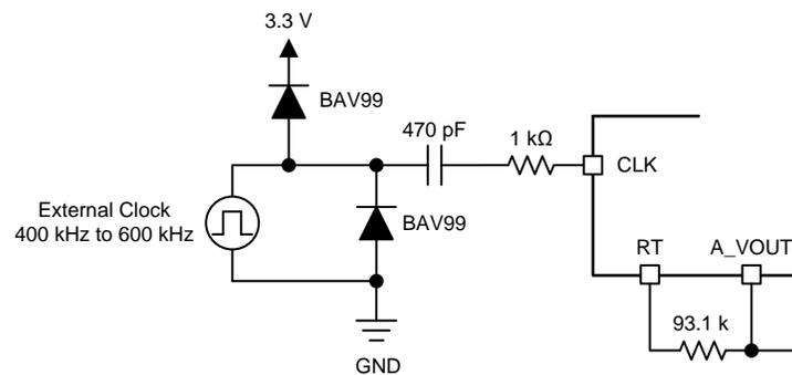
图 33. CLK Configuration (500-kHz Typ)
