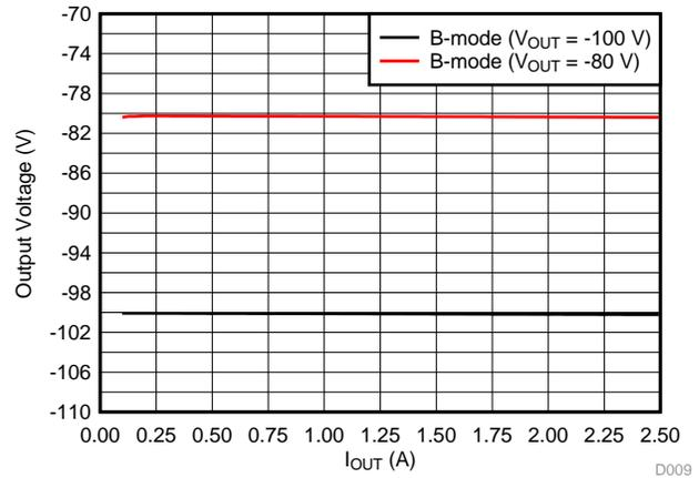
图 54. B-Mode Load Regulation (-HV Output)
