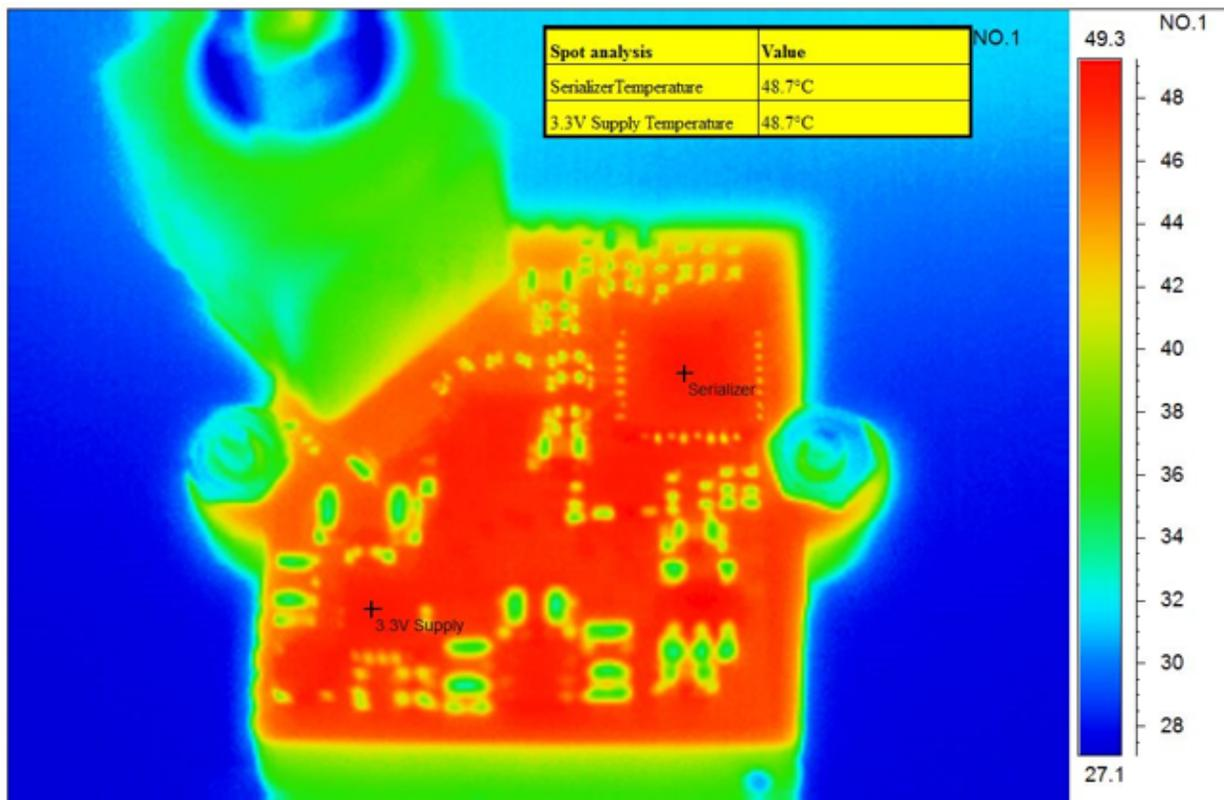
图 20. Thermal Measurement
