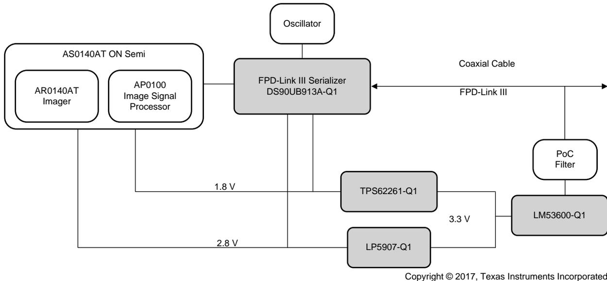
图 1. TIDA-01003 Block Diagram
