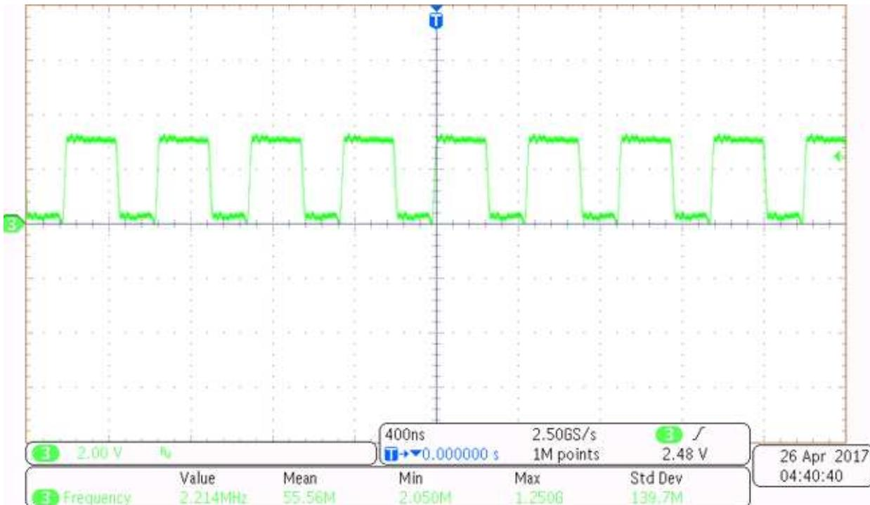
图 17. 1.8-V Switching Waveform
