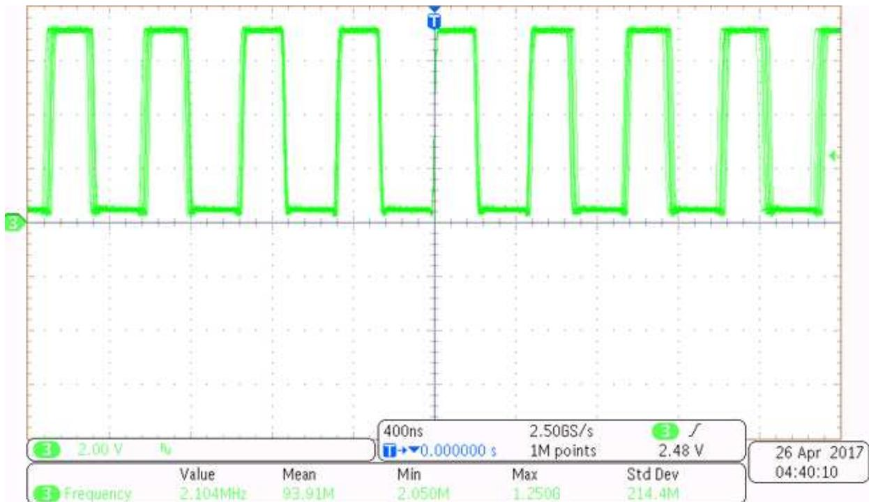
图 18. 3.3-V Switching Waveform
