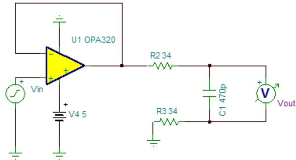
图 24. TINA-TI™ Schematic—Checking Input Driver Noise
