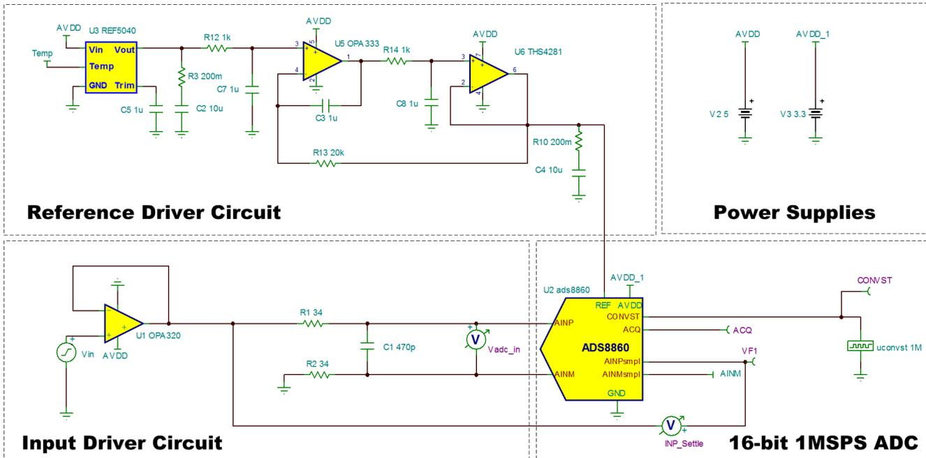
图 19. TINA-TI™ Schematic—Complete DAQ Block
