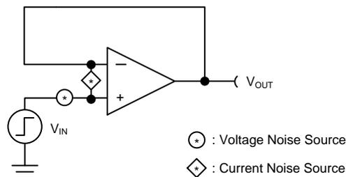
图 13. Intrinsic Noise of Input Driver
