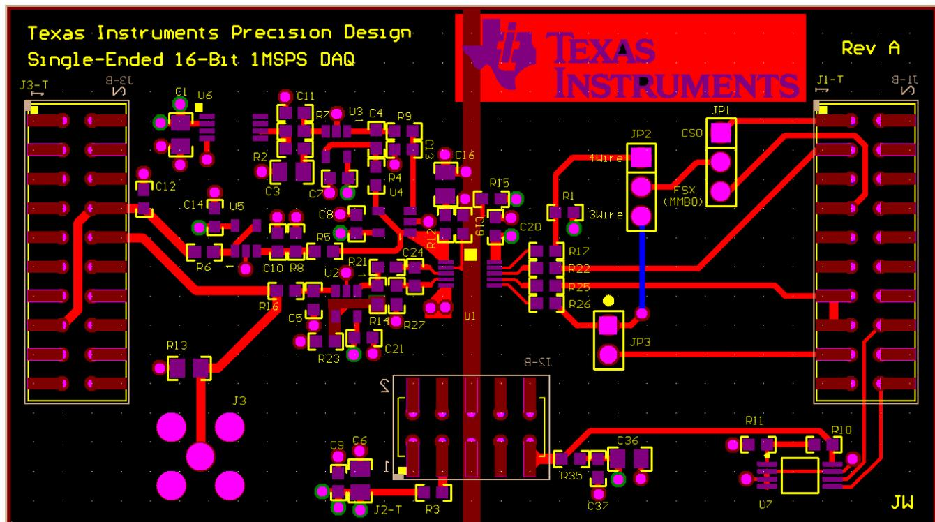
图 31. 16-Bit, 1-MSPS, Single-Ended DAQ Block PCB Layout
