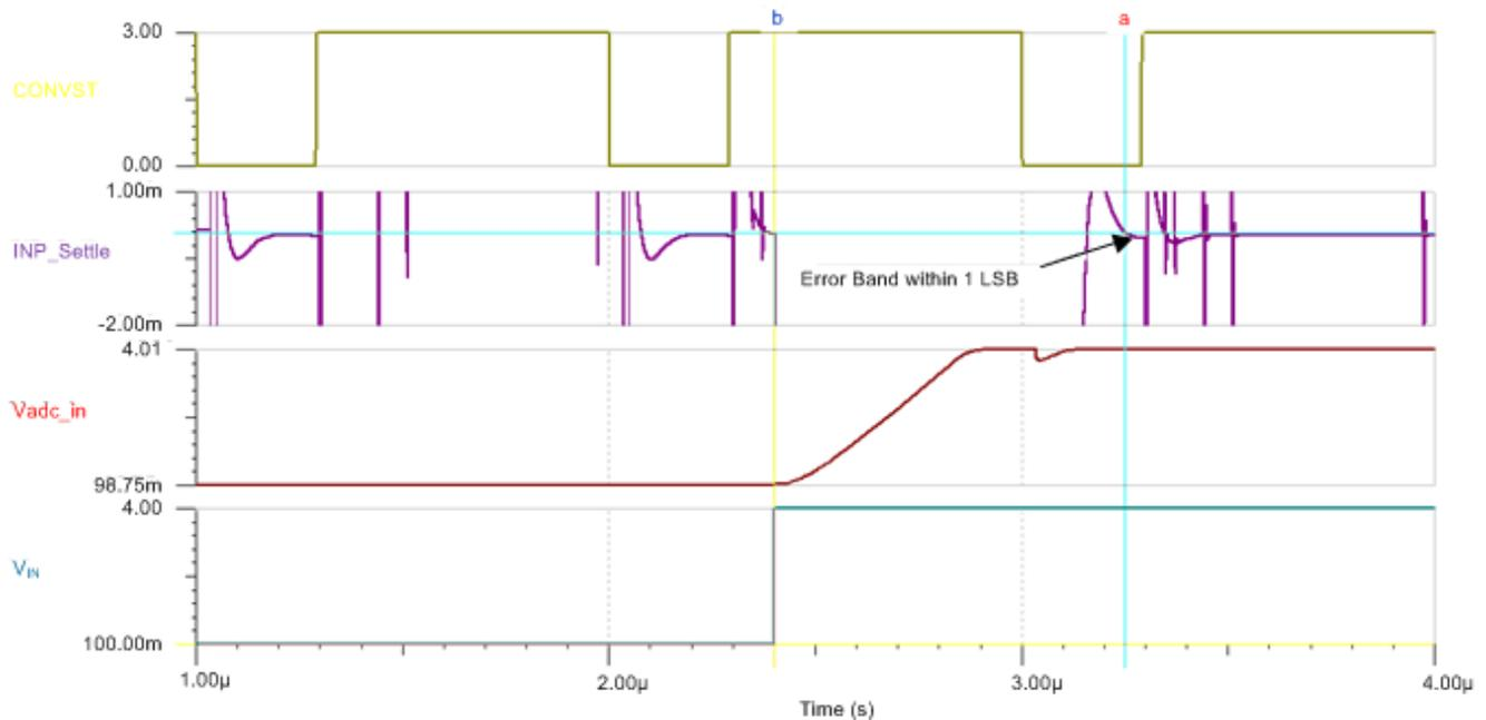
图 20. TINA-TI™ Simulation Result—ADC Input Settling Rising
