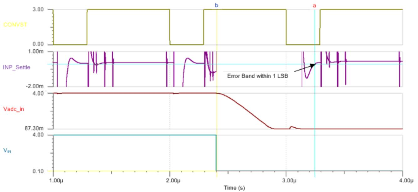
图 21. TINA-TI™ Simulation Result—ADC Input Settling Falling
