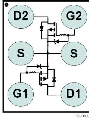
图 8. CSD75208W1015 Device Configuration
