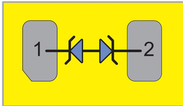
图 9. TPD1E10B06 Functional Block Diagram
