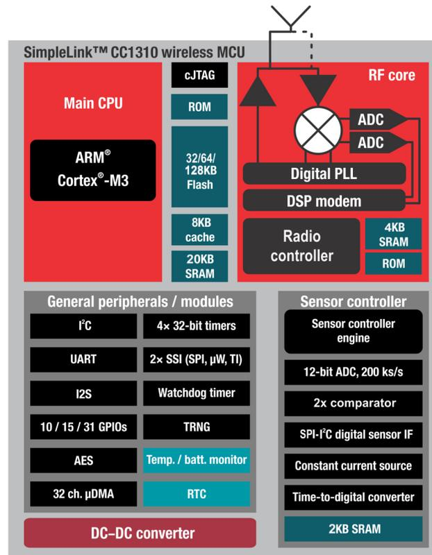
图 4. CC1310 Functional Block Diagram
