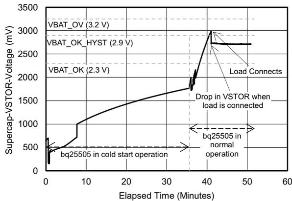
图 22. Supercap Charging Under 250 LUX
