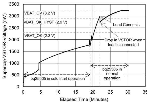
图 21. Supercap Charging Under 450 LUX
