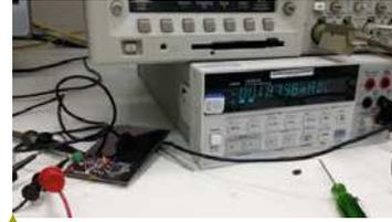
图 16. 250 LUX Light Intensity Measurement Setup
