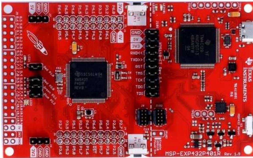
图 6. 带跳线配置的 MSP-EXP432P401R
