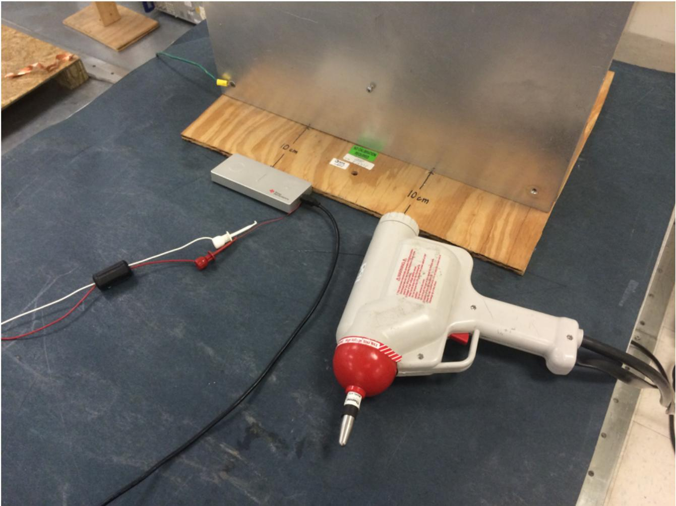
图 54. IEC 61000-4-2 ESD Test Setup
