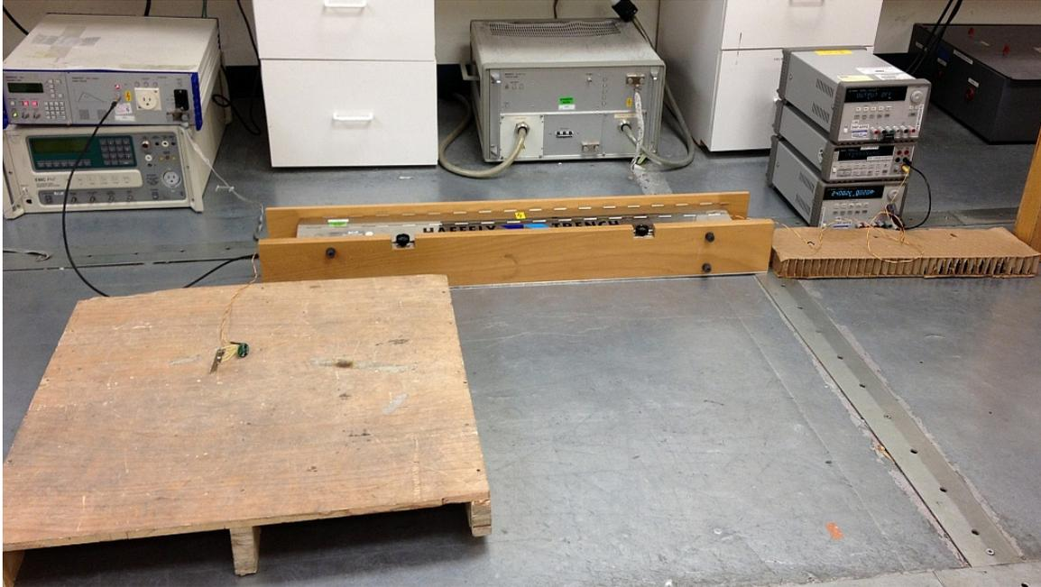
图表 B-8: IEC 61000-4-4 EFT 测试硬件设置
