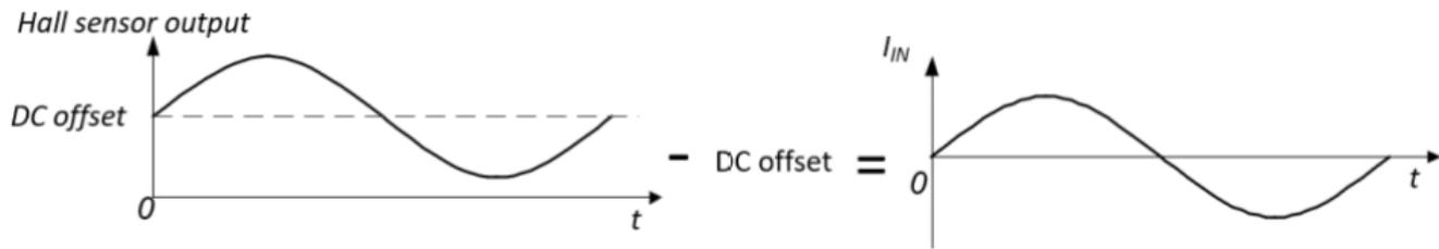
图 7. 使用霍尔传感器输出的波形和直流失调计算  $I_{IN}$ 。来源：德州仪器 (TI)
