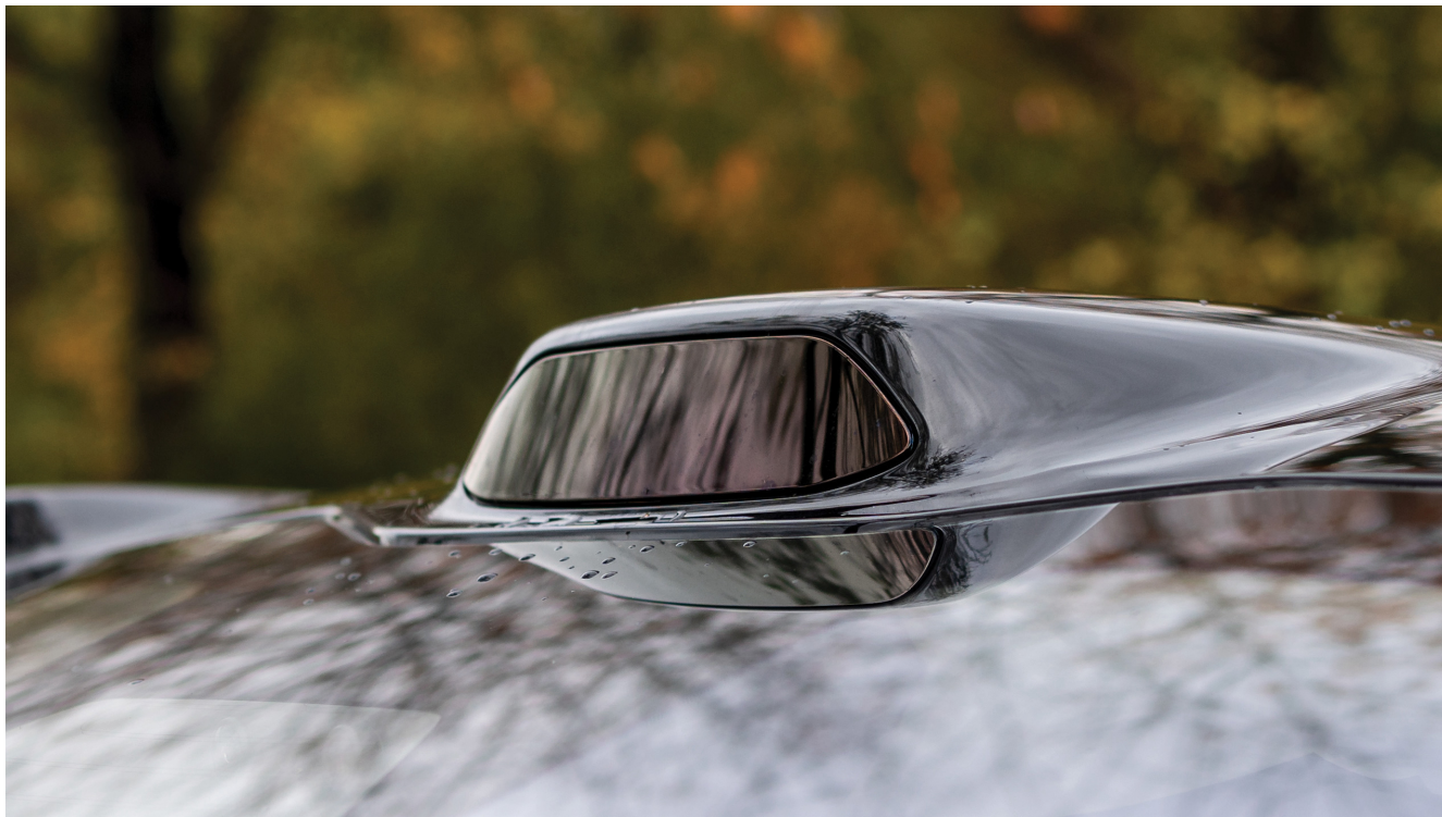
图 2. 安装在车辆顶部的激光雷达模块
