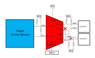
图 2. 使用 2:1 双通道多路复用器进行 I2C 通信,防止控制器发生故障
