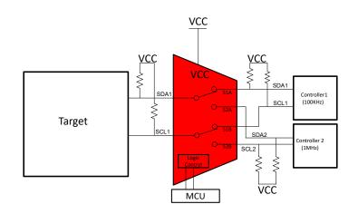
图 1. 用于 I2C 通信的 2:1 双通道多路复用器的示例应用
