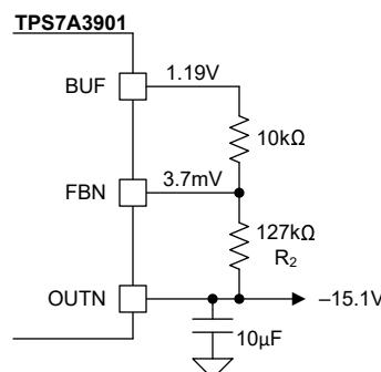
设输出为  $-15\text{V}$  , BUF 与 FBN 之间的电阻为  $10\text{k}\Omega$  , 则可计算出底部电阻器 :
