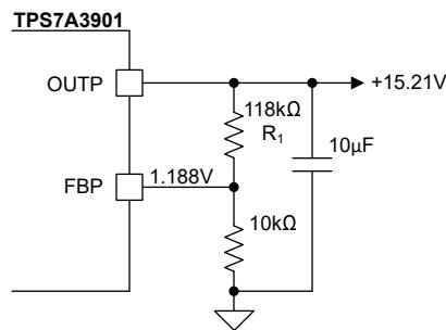
设输出为 15V , FBP 与接地之间的电阻为  $10\text{k}\Omega$  , 则可计算出顶部电阻器 :
