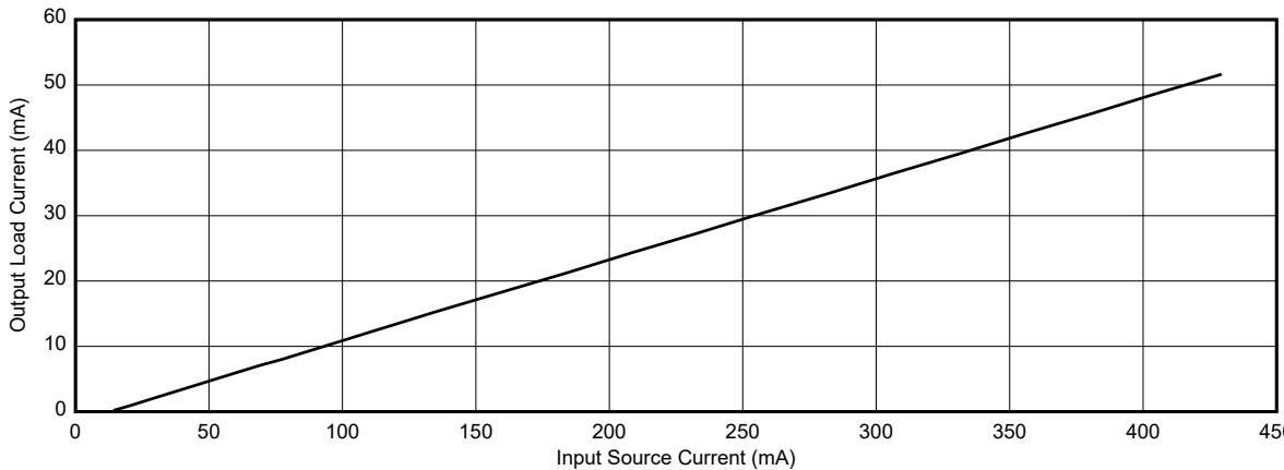
根据对所搭建电路的测量，输入电流超过输出负载电流的八倍。对于提供 500mA 的标准 USB 2.0 端口， $\pm 15V$  电源的最大输出电流可达到约 60mA。
