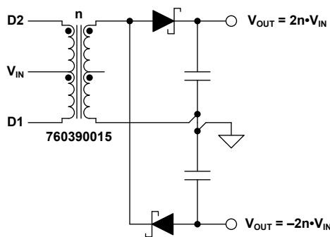
SN6505B 通过开关 D1 和 D2 产生周期信号。这些周期通过中心抽头变压器推入或拉出电流。开关周期交替进行，在整流器二极管后提供正负电压输出。下图显示了开关周期期间的输出电流路径。
