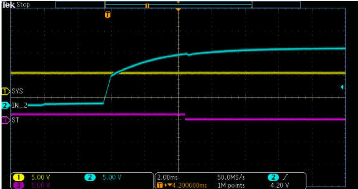
图 2-8. 测试六：添加了 100uF 电容、3A 输出电流
