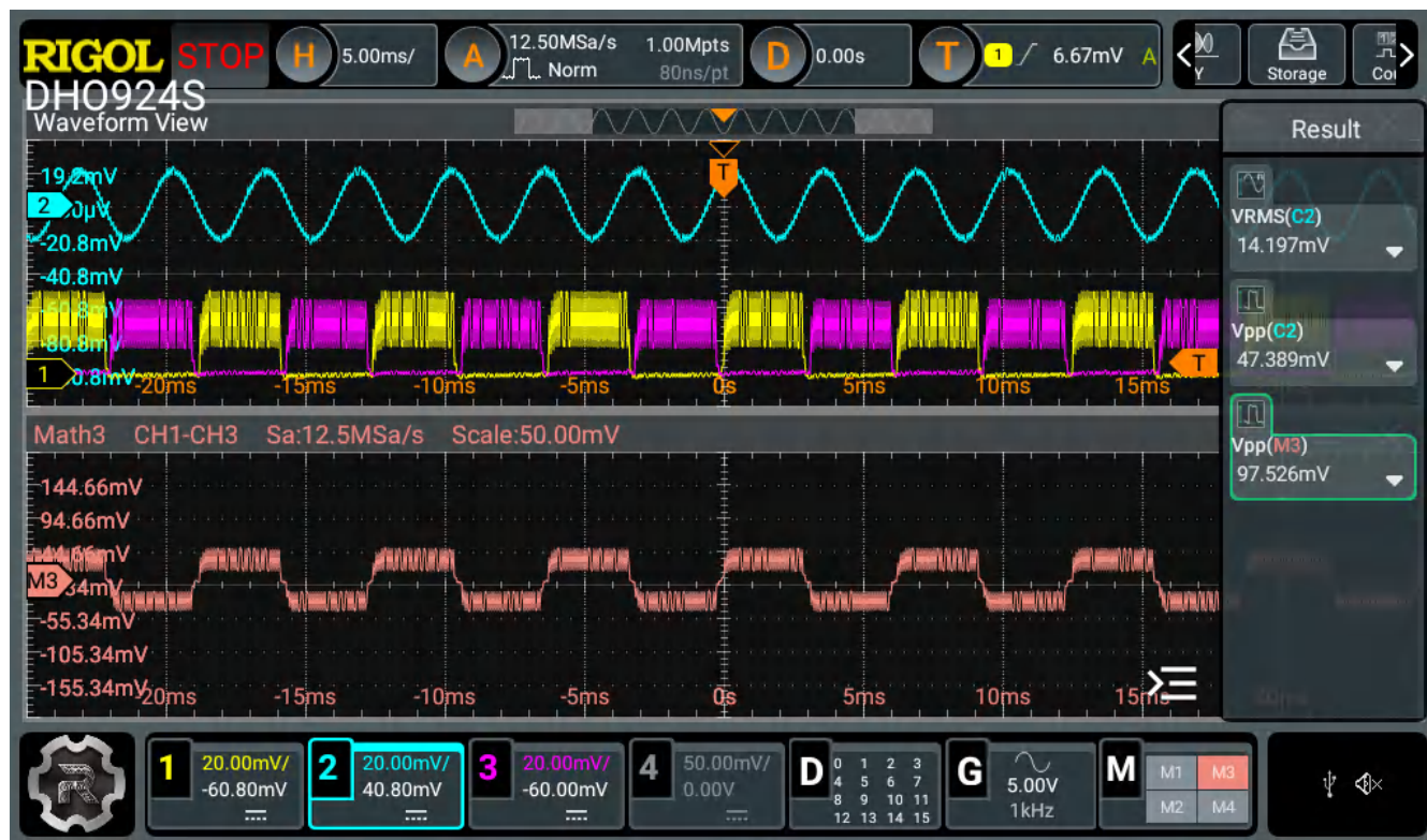
图 4-11. 75% 音量下的 300Hz 输入 - 柔和振动
