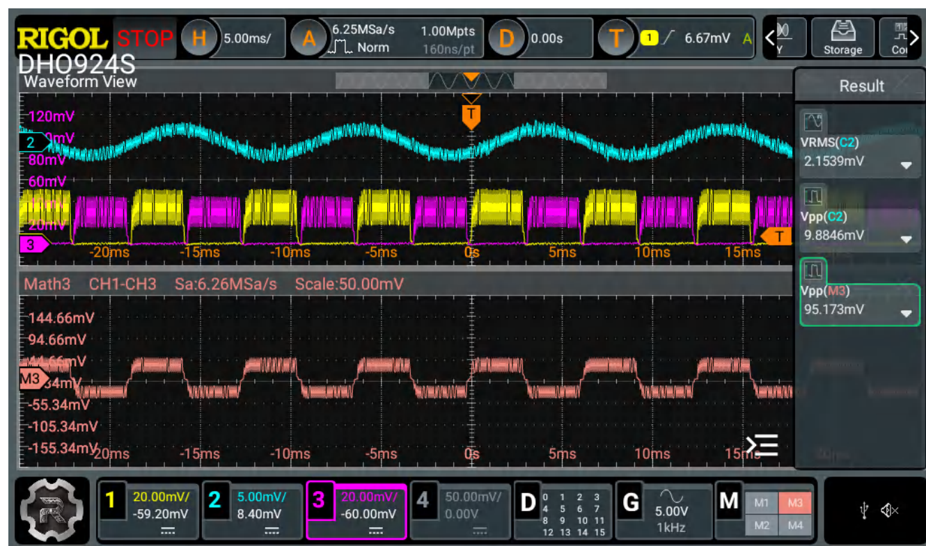
图 4-1. 25% 音量下的 100Hz 输入 - 微弱振动
