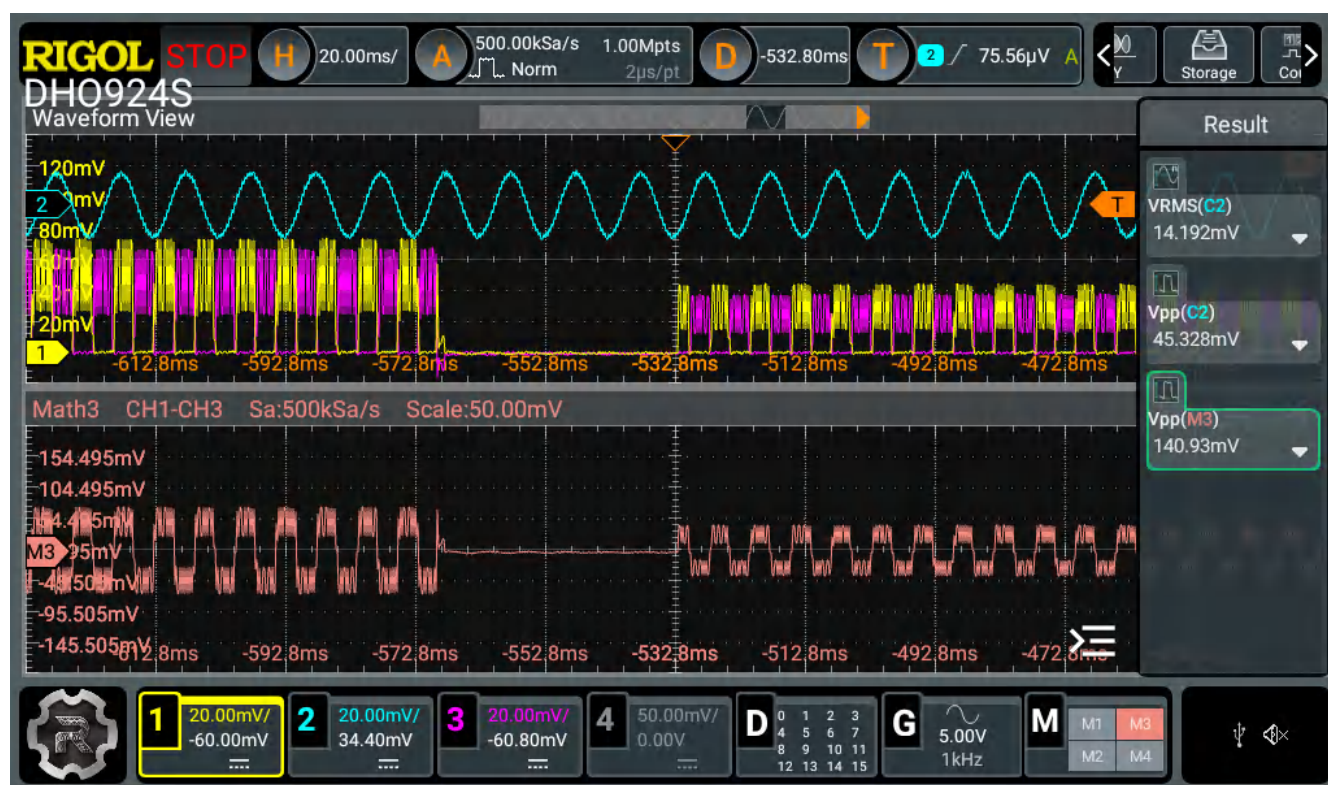
图 5-2. 使用切换时调零驱动器的技术，从音频转触觉模式切换到 RTP 模式
