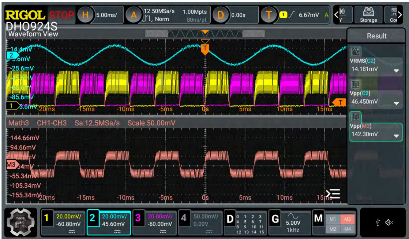
图 4-3. 75% 音量下的 100Hz 输入 - 强烈振动
