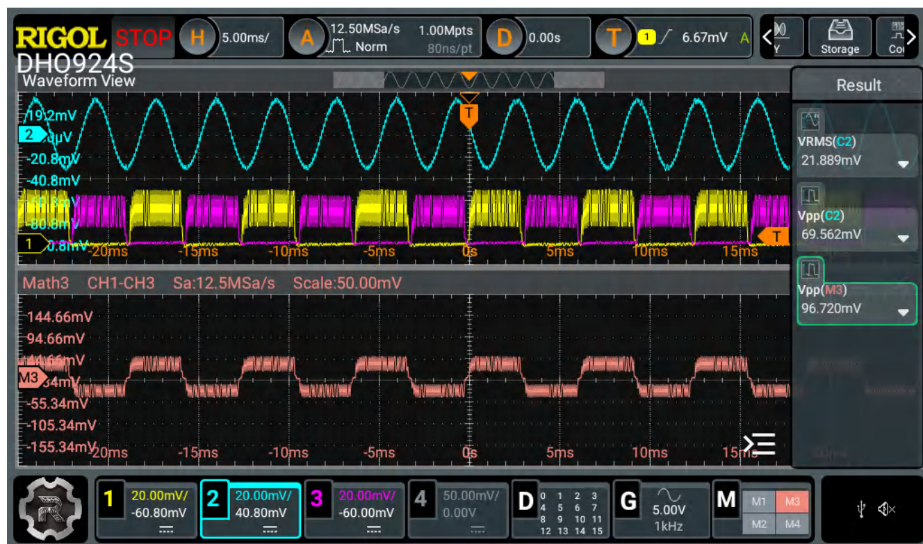
图 4-12. 100% 音量下的 300Hz 输入 - 弱振动响应
