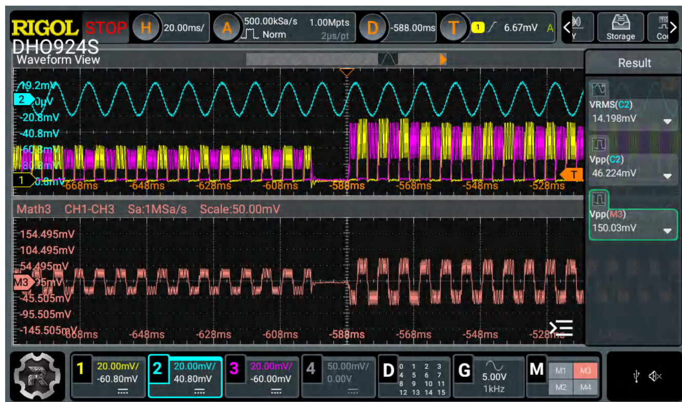
图 5-1. 播放 100Hz 音频音时从 RTP 模式切换到音频转触觉模式
