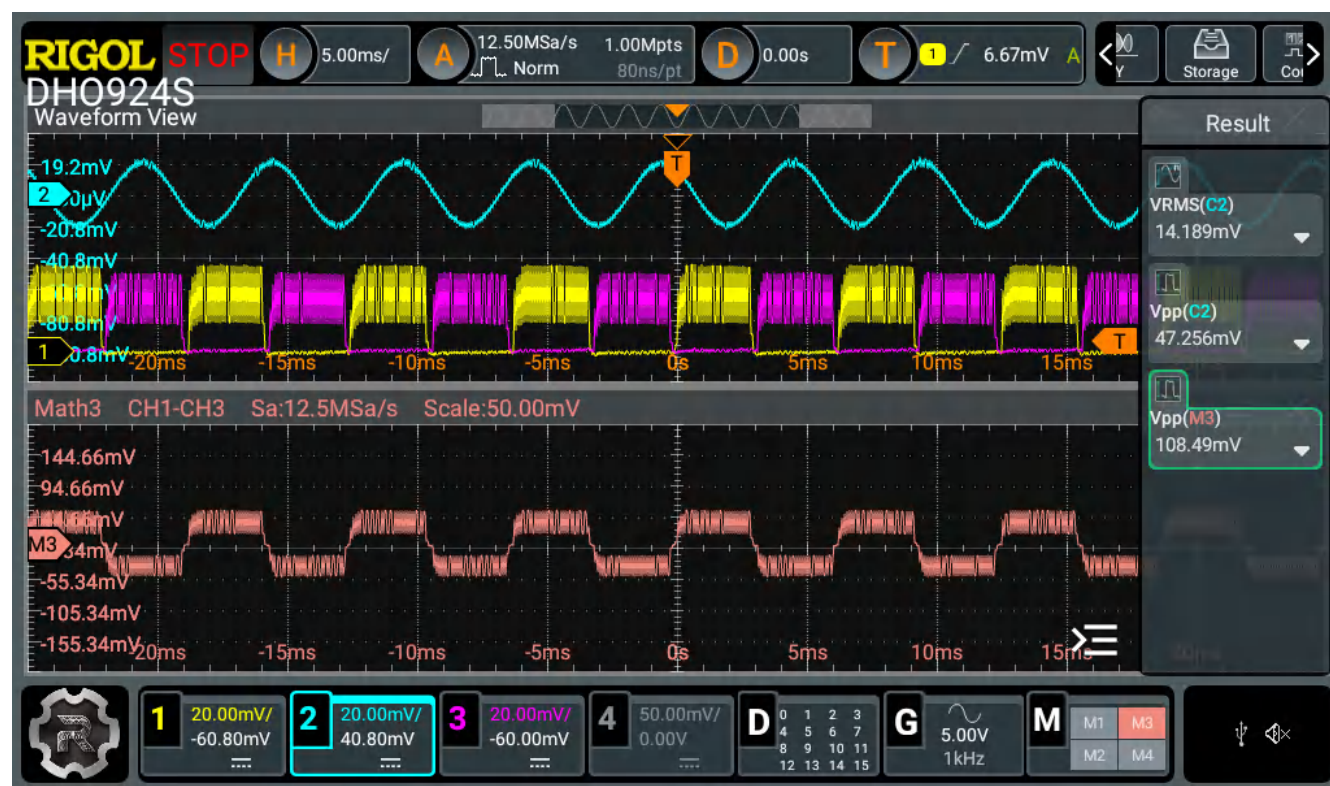
图 4-7. 75% 音量下的 200Hz 输入 - 高 PWM 活动
