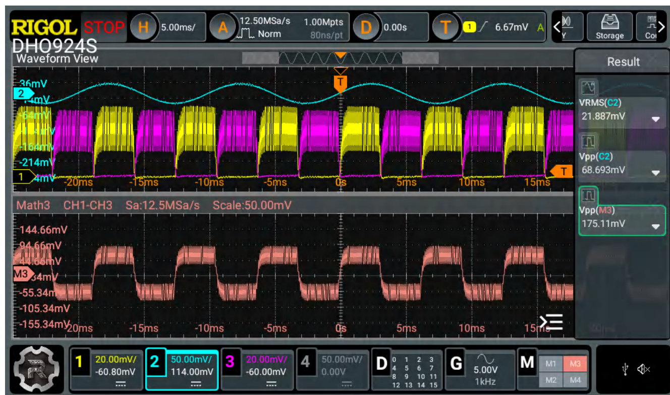
图 4-4. 100% 音量下的 100Hz 输入 - 满量程振动
