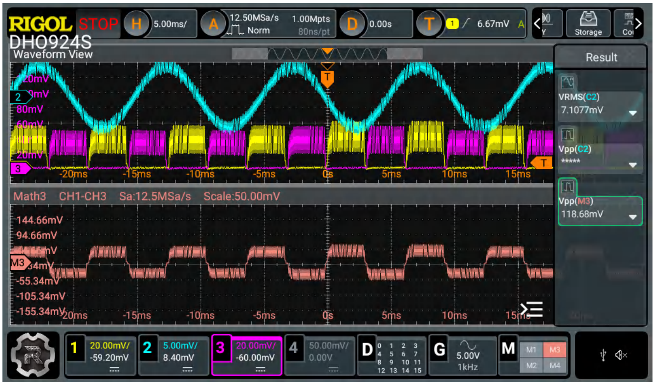
图 4-2. 50% 音量下的 100Hz 输入 - 明显振动
