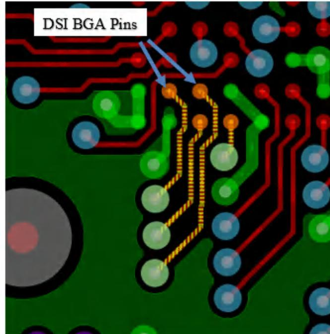
图 9-1. 顶层的串行器/解串器 DSI 迂回
