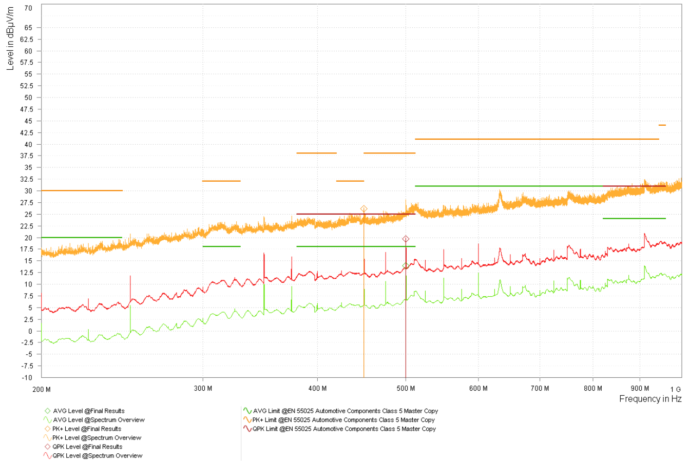
图 3-19. 竞品振荡器 3.3V 频谱概述 - 对数周期
