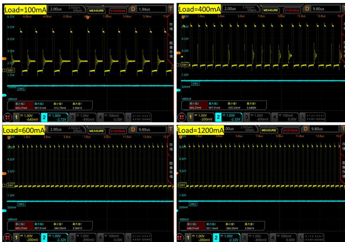
Figure 12. SW 随负载电流变化 1
