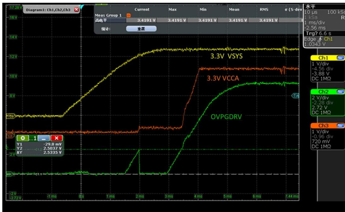
Figure 6. TPS6594 Fail Short BIST PASS 的波形
