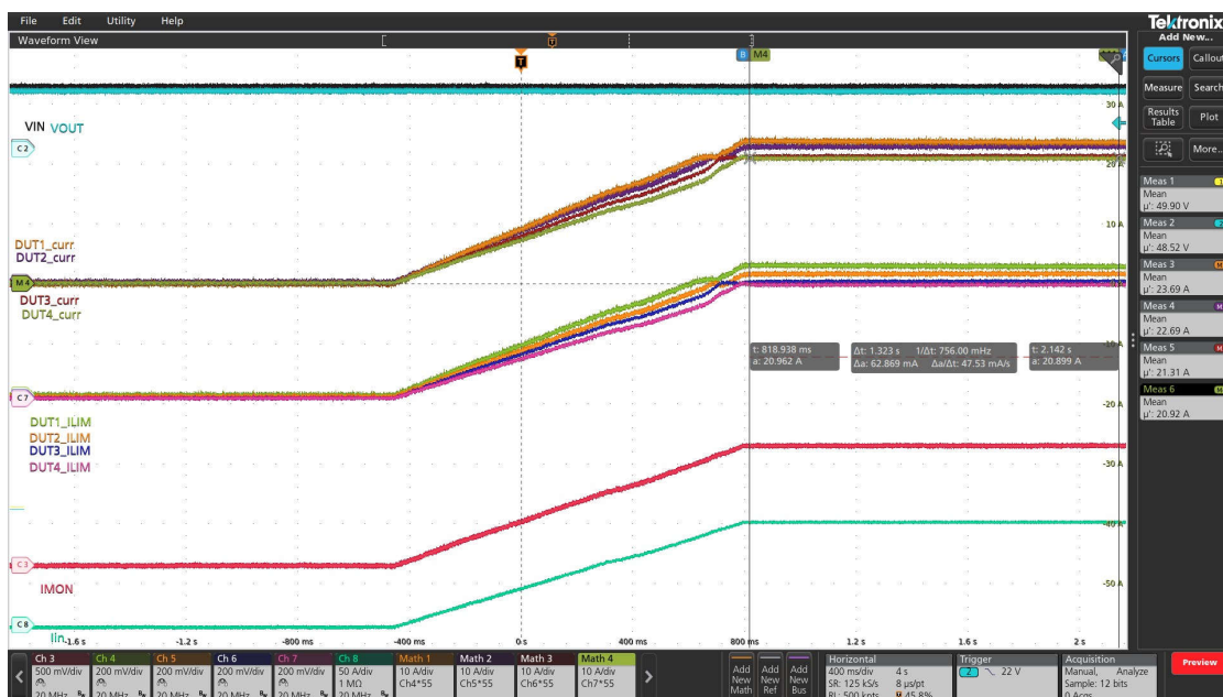
图 3-3. 四个无 ACS 的电子保险丝之间的均流
