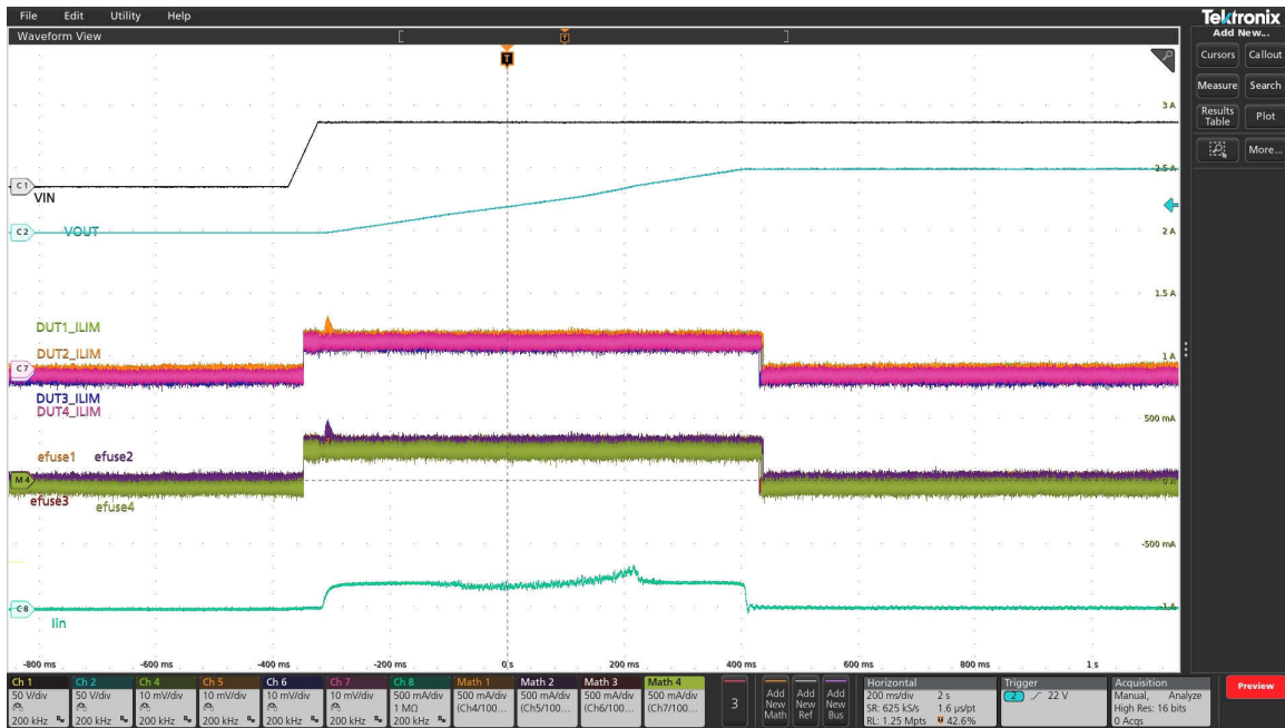
图 3-6. 启动期间四个 TPS1685 电子保险丝之间的电流分配
